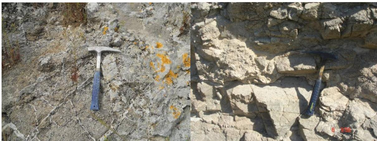
**Figura 17 - Affioramento del substrato granitico intensamente fratturato affiorante nel settore meridionale (sinistra) e nord-orientale (destra) dell'area di studio.**
