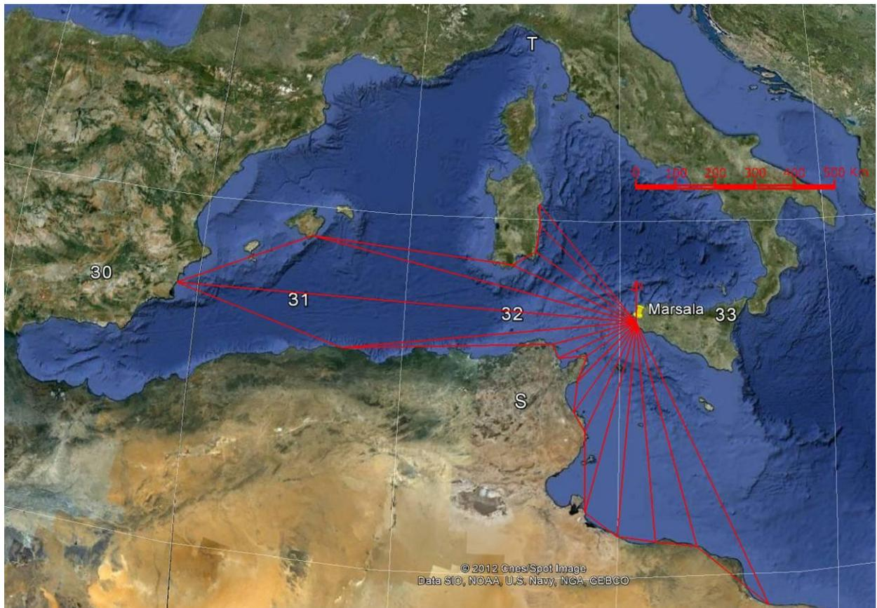
Figura 1.3 Fetch geografico stimato sulla base delle distanze misurate sulla vista satellitare.
