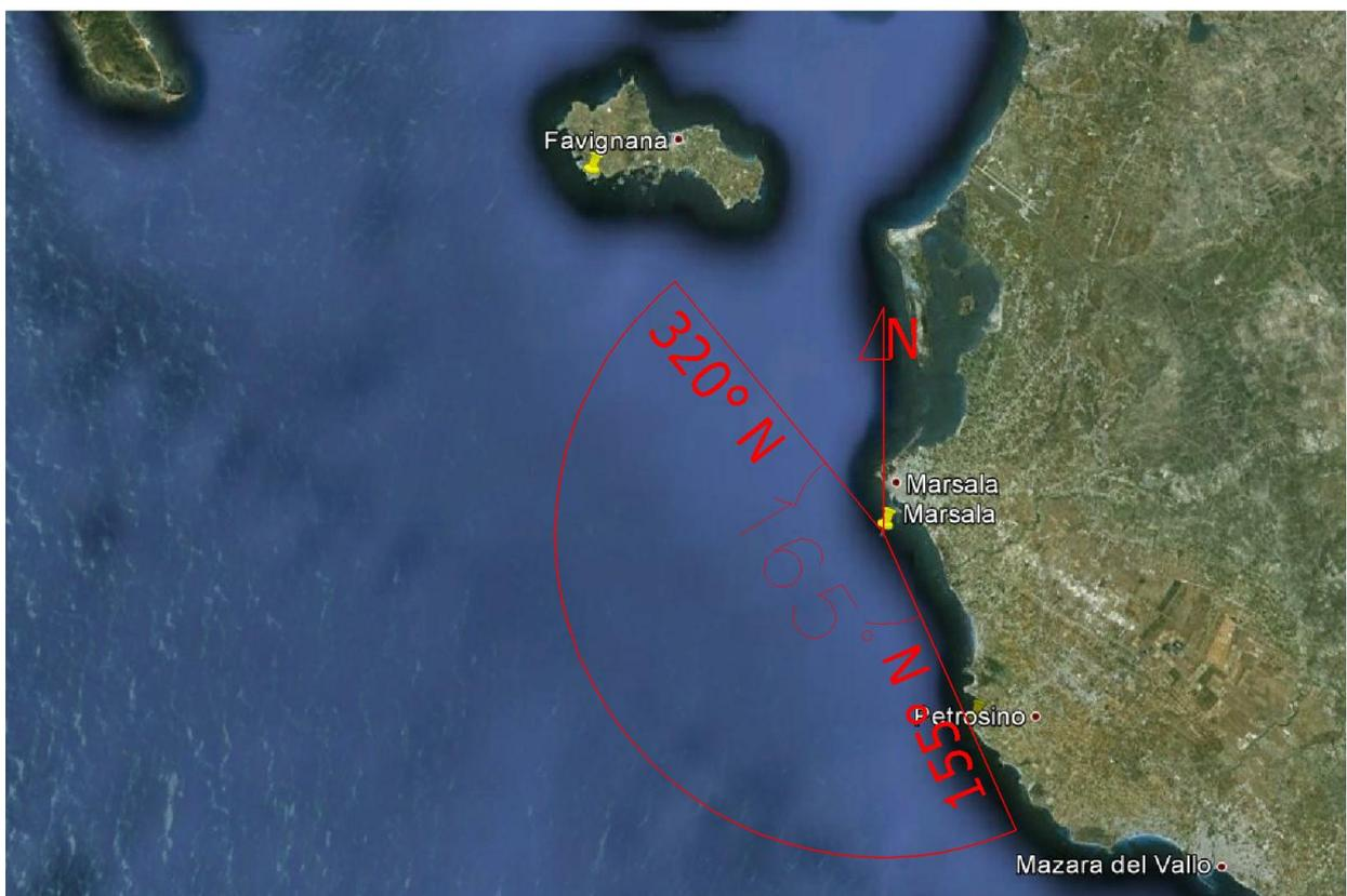
Figura 1.2 Settore di traversia del tratto di mare antistante il porto di Marsala.
