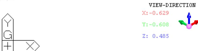
L'origine del sistema di riferimento globale non ha importanza ai fini delle calcolazioni numeriche eseguite: esso influisce esclusivamente sul valore numerico delle coordinate nodali. È pertanto possibile scegliere tale origine in un qualsiasi punto di comodo anche esterno alla struttura esaminata.
