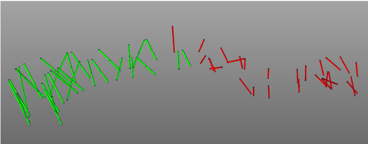
Figura 4.17 – Particolare colonne: diametro 610 mm (in verde), diametro 508 mm (in rosso)
