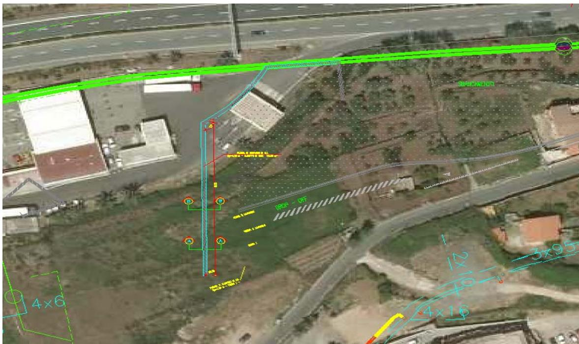
Figura 4.1: Stralcio planimetrico dell'opera con indicazione dei sottoservizi esistenti
