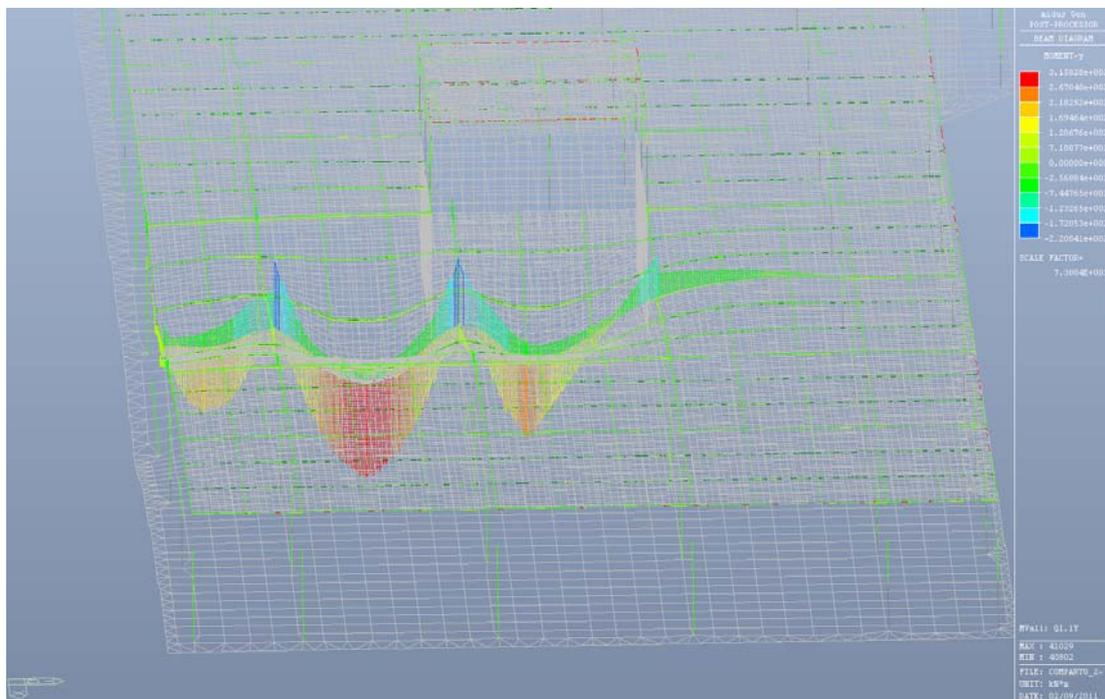
Figura 6.16 – Momento flettente  $M_y$  - Condizione di carico Q1.1y
