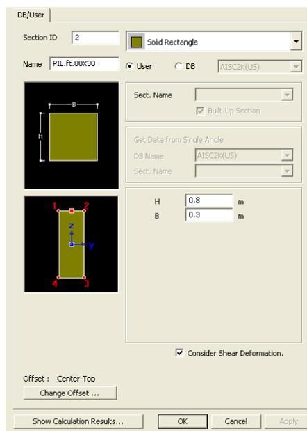
Figura 4.22 – Caratteristiche geometriche delle sezioni trasversali dei pilastri del torrino scala
