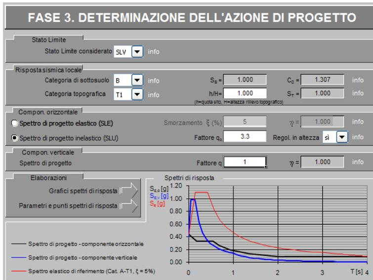
Figura 4.15 – Determinazione dello spettro di progetto relativo allo SLV
