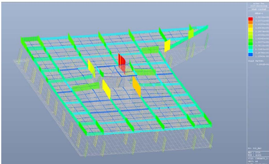
Fig. 6.36 – Taglio Fz - Condizione di carico SLD\_Max
