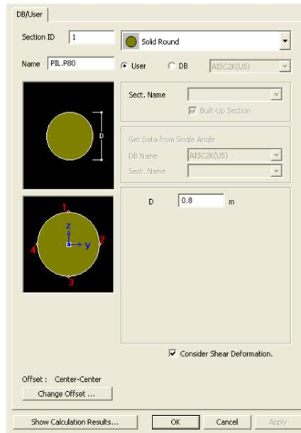
Figura 4.21 – Caratteristiche geometriche delle sezioni trasversali dei pilastri
