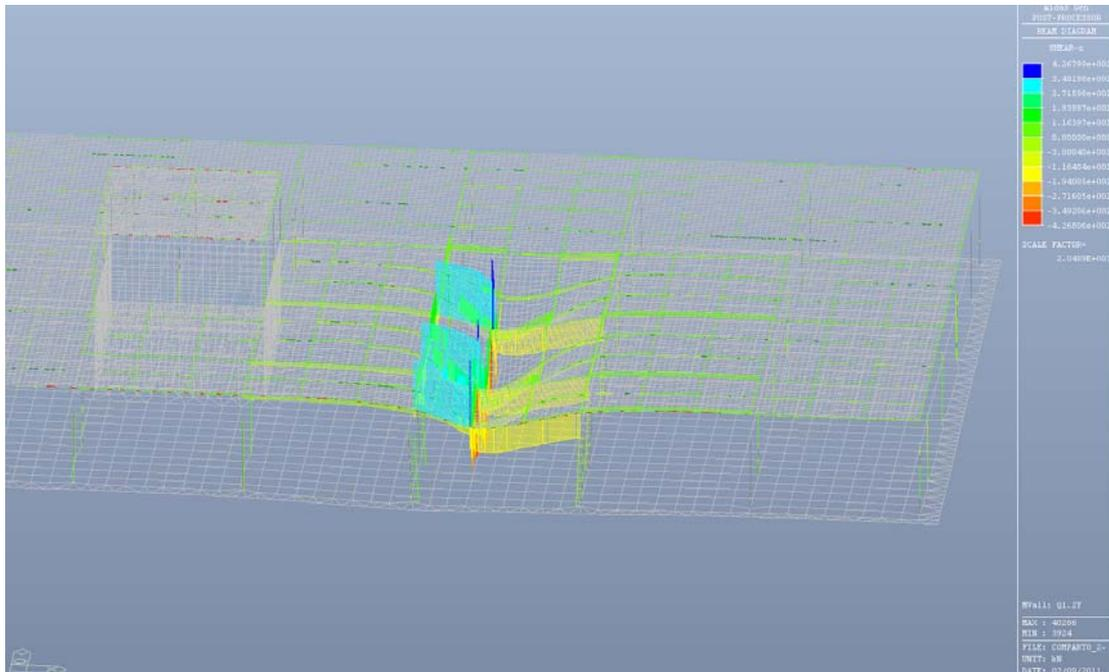
Fig. 6.35 – Taglio Fz - Condizione di carico Q1.2y
