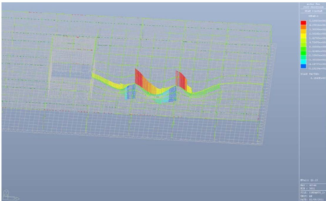
Fig. 6.32 – Taglio Fz - Condizione di carico Q1.1x
