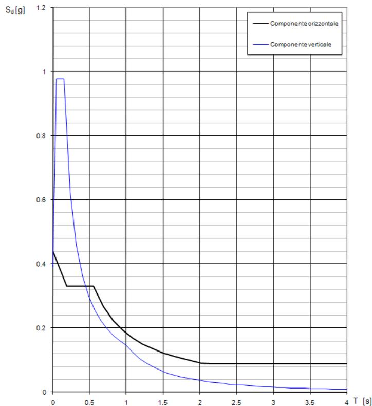
Figura 4.16 – Spettro di progetto relativo allo SLV
