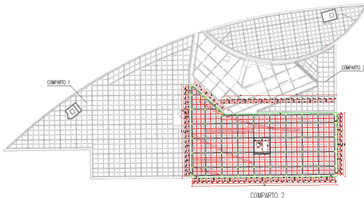
Figura 4.1– Carpenteria del primo impalcato del corpo n. 2
