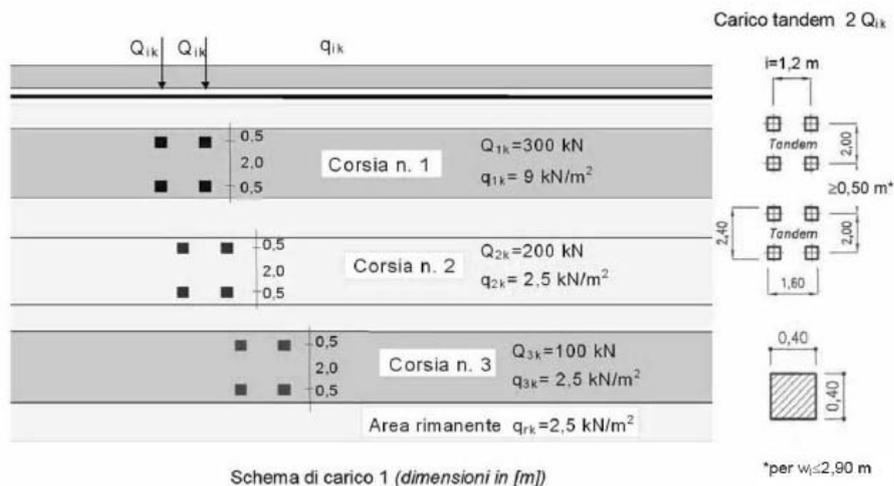
Figura 4.5 – Schema di carico 1
