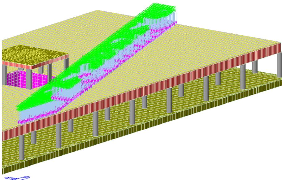
Figura 4.7 – Esempio di corsia di carico
