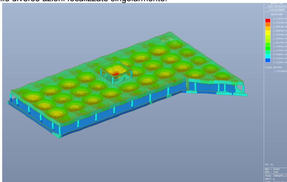
Figura 6.1 – Deformate per effetto dei pesi propri strutturali – G1
