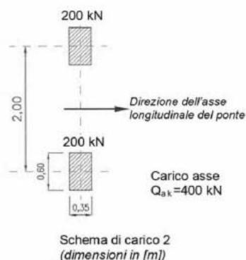
Figura 4.6 – Schema di carico 2
