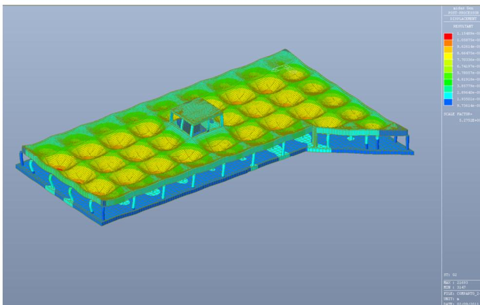
Figura 6.2 – Deformate per effetto dei carichi permanenti portati – G2
