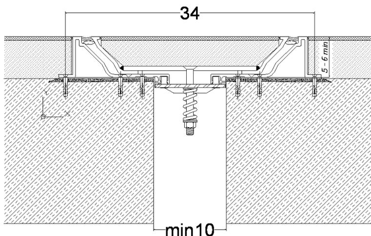
Oltre ad assicurare gli spostamenti risultanti dal calcolo, nei casi in cui si vuole mantenere l'isolamento strutturale tra gli edifici in c.a. e le paratie preposte al sostegno del terreno e dei manufatti ubicati oltre il limite delle aree da edificare, il giunto utilizzato è capace di garantire quegli spostamenti che s'imporrebbero come effetto locale.
