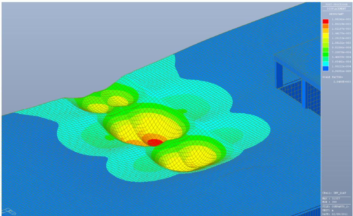
Figura 6.5 – Deformate per effetto dei carico mobile in dir. Y – Q1AY (invil. max e min spostamenti)
