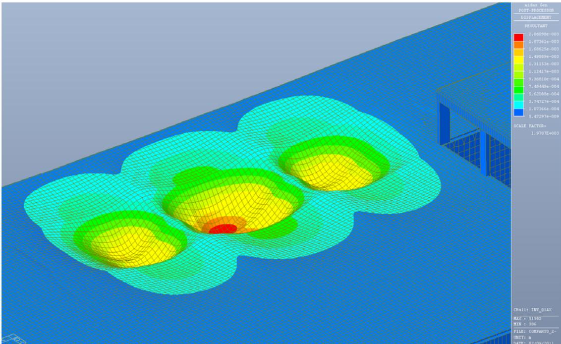
Figura 6.4 – Deformate per effetto del carico mobile in dir. X – Q1AX (invil. max e min spostamenti)
