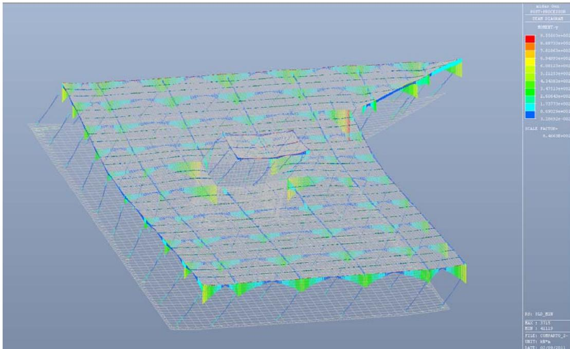
Figura 6.21 – Momento flettente  $M_y$  - Condizione di carico SLD\_Min
