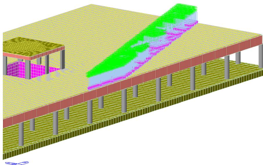
Figura 4.8 – Esempio di corsia di carico
