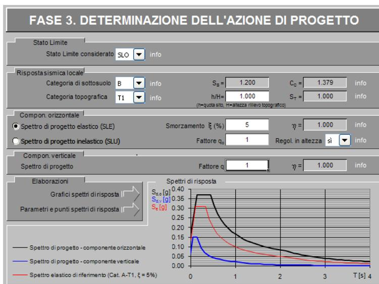
Fig. 4.11 – Determinazione dello spettro di progetto relativo allo SLO
