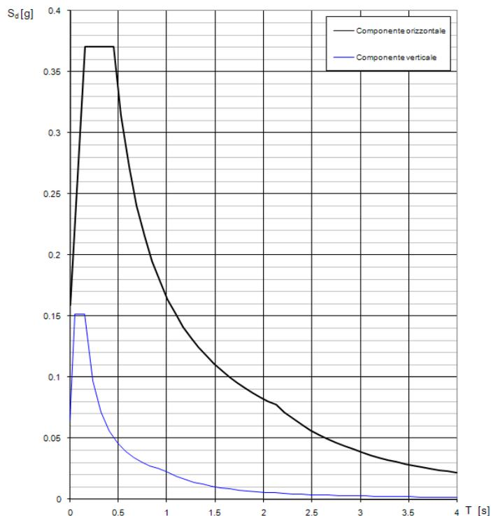
Fig. 4.12 – Spettro di progetto relativo allo SLO
