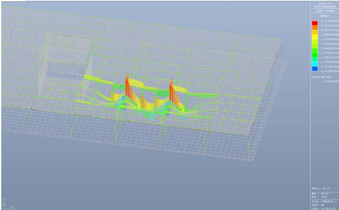
Fig. 6.33 – Taglio Fz - Condizione di carico Q1.2x
