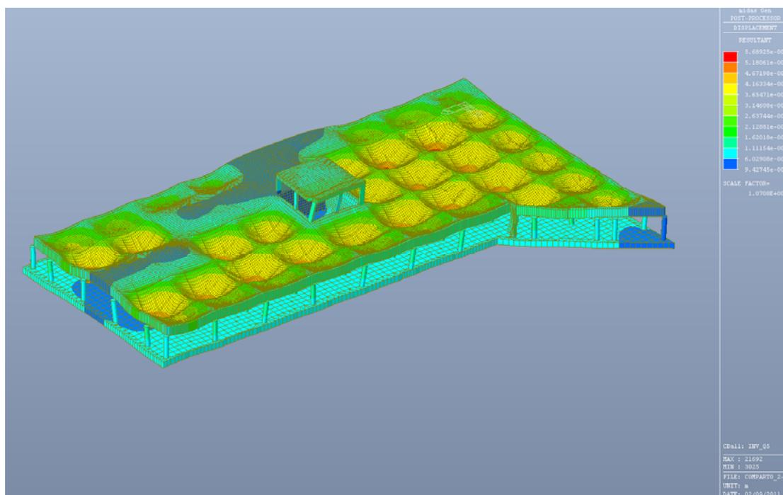
Figura 6.3 – Deformate per effetto dei carico della folla compatta – Q5 (inviol. max e min spostamenti)
