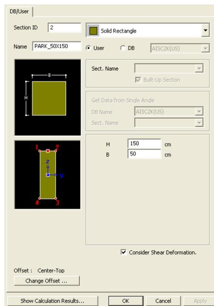
Figura 4.19 – Caratteristiche geometriche delle sezioni trasversali delle travi principali (piazza)
