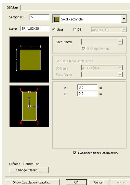
Figura 4.23 – Caratteristiche geometriche delle sezioni trasversali delle travi del torrino scala
