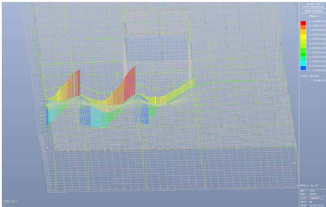
Fig. 6.34 – Taglio Fz - Condizione di carico Q1.1y
