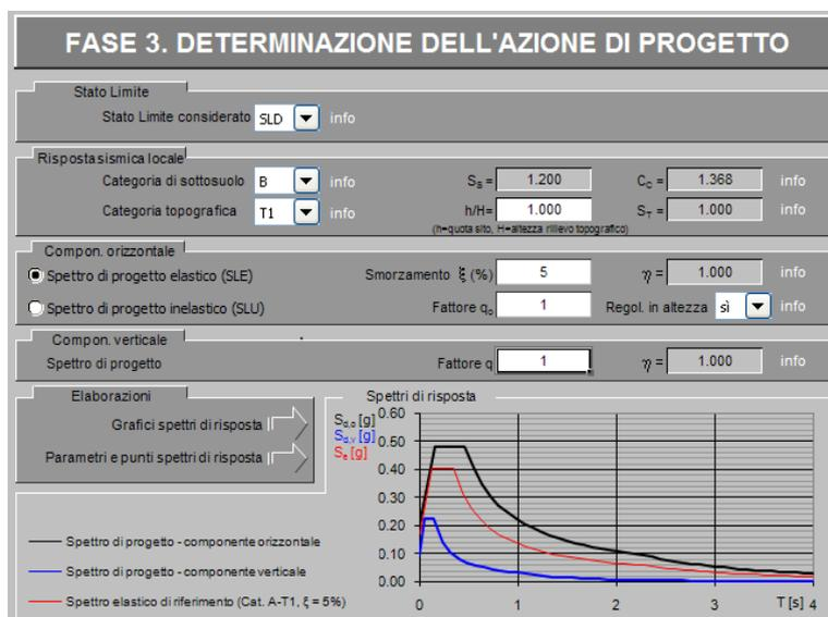
Fig. 4.13 – Determinazione dello spettro di progetto relativo allo SLD
