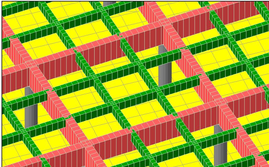
Figura 4.18 – Particolare delle travi principali (in rosso) e delle travi secondarie (in verde)
