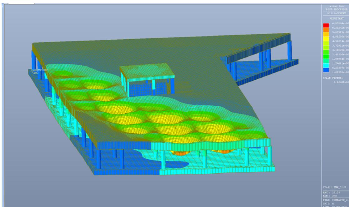
Figura 6.6 – Deformate per effetto dei carico mobile in dir. trasv. – Q1B (inviol. max e min spostamenti)
