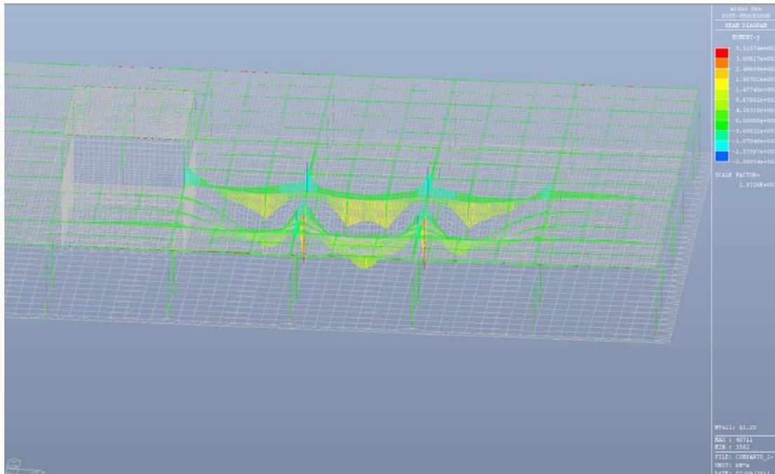
Figura 6.15 – Momento flettente  $M_y$  - Condizione di carico Q1.2x
