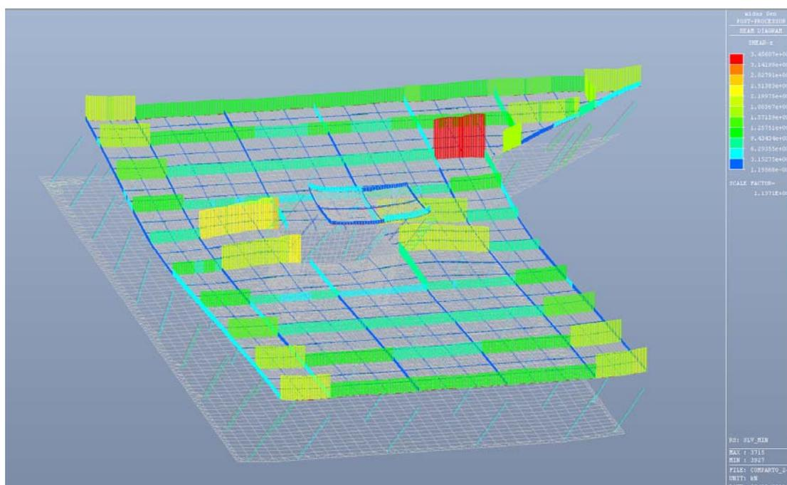
Fig. 6.41 – Taglio Fz - Condizione di carico SLV\_Min
