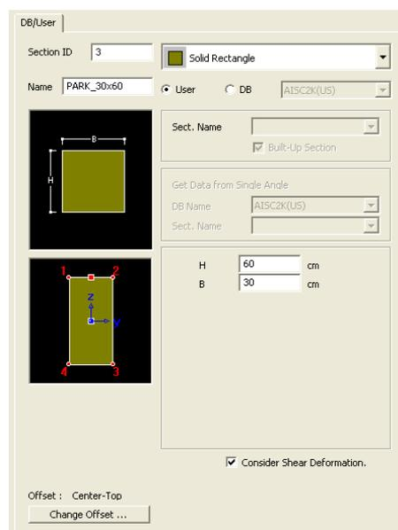
Figura 4.20 – Caratteristiche geometriche delle sezioni trasversali delle travi secondarie (piazza)
