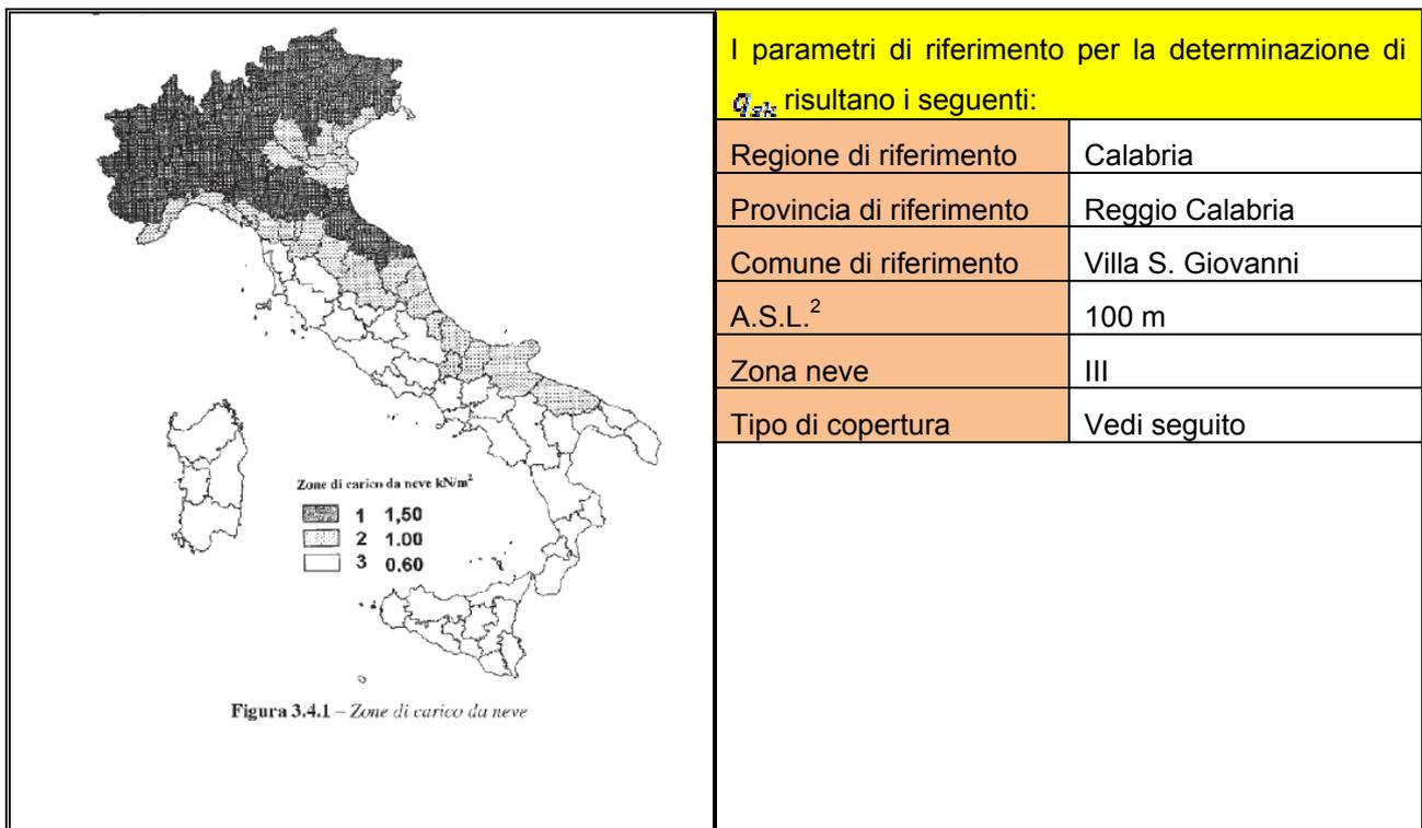
Figura 4.4 – Parametri valutazione carico neve
