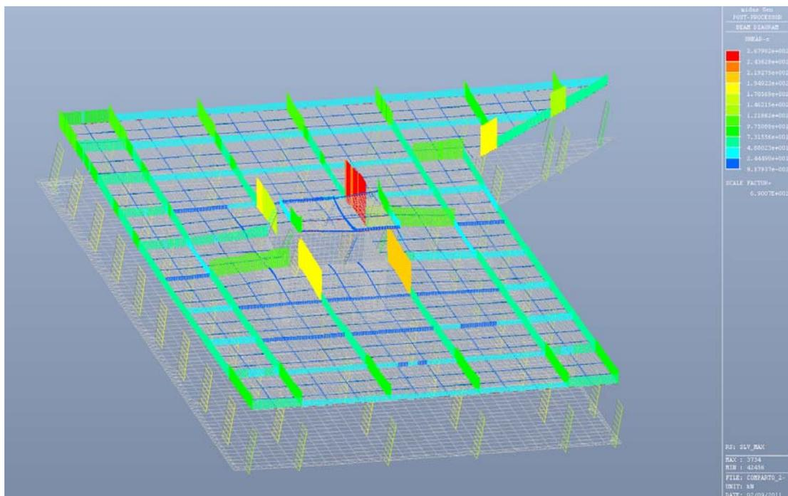
Fig. 6.40 – Taglio Fz - Condizione di carico SLV\_Max
