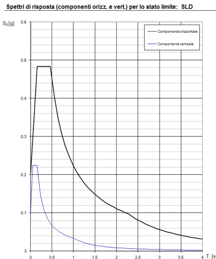
Figura 4.14 – Spettro di progetto relativo allo SLD
