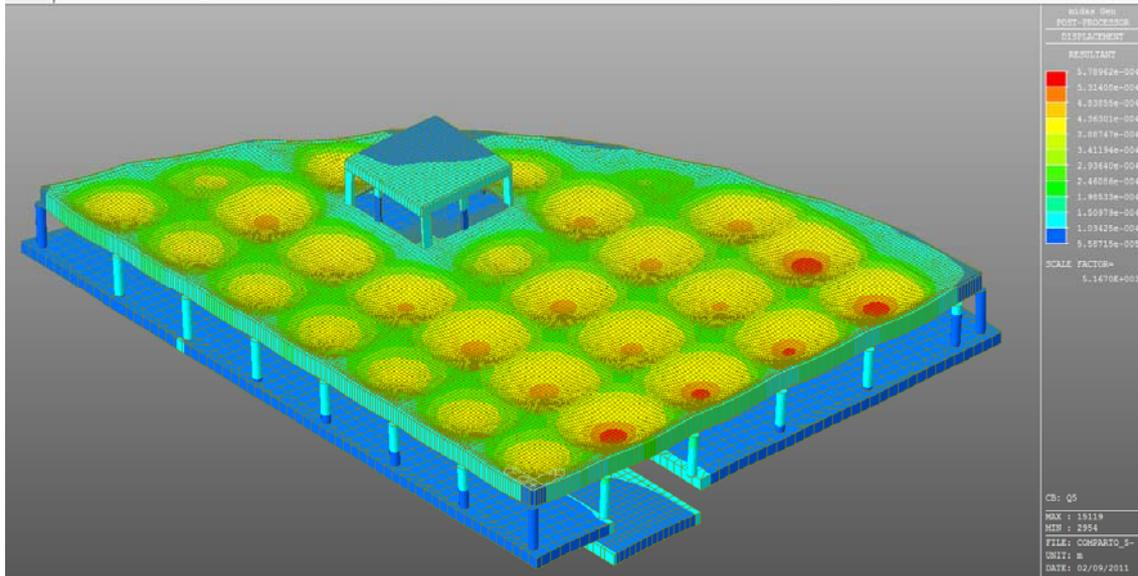
Figura 6.3: Deformate per effetto dei carico della folla compatta – Q5 (inviol. max e min spostamenti)
