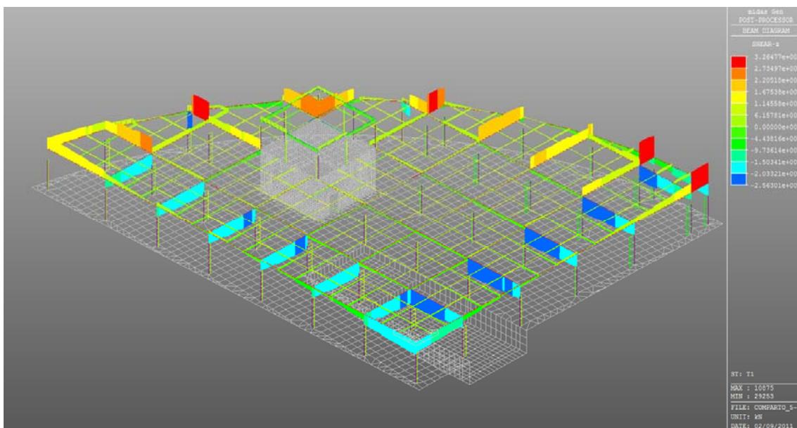
Figura 6.34: Caso di carico T1 (termico) – Valore del taglio
