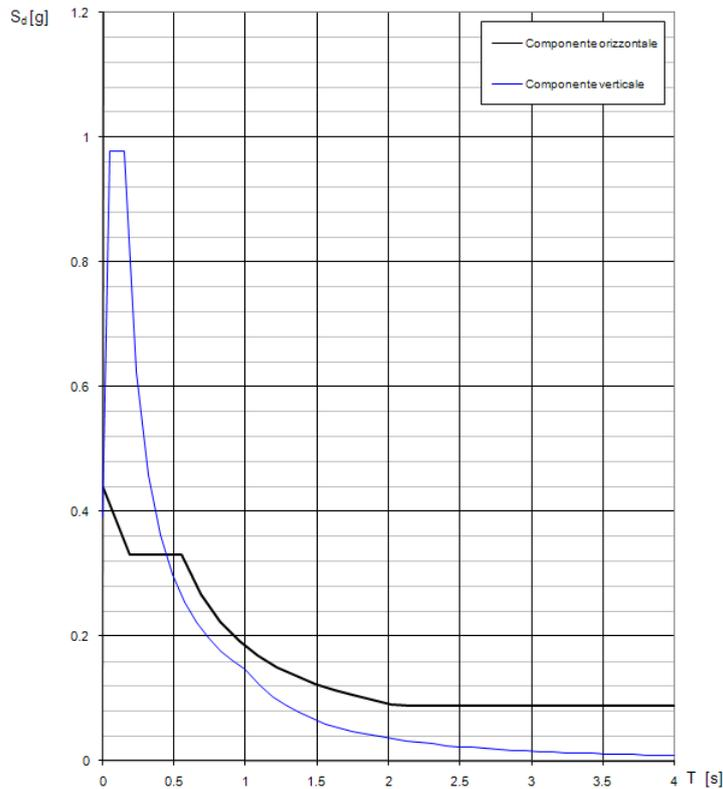
Figura 4.13: Spettro di progetto relativo allo SLV
