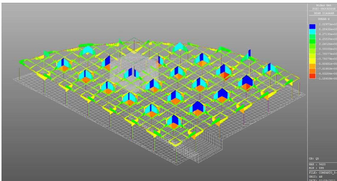
Figura 6.27: Involuppo del carico Q5 (folia) – valore del taglio
