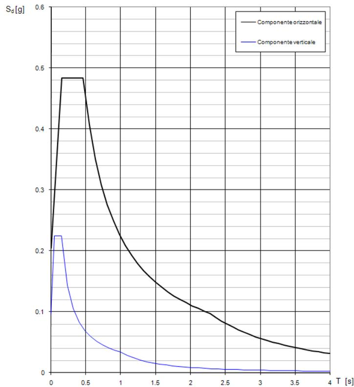
Figura 4.11: Spettro di progetto relativo allo SLD
