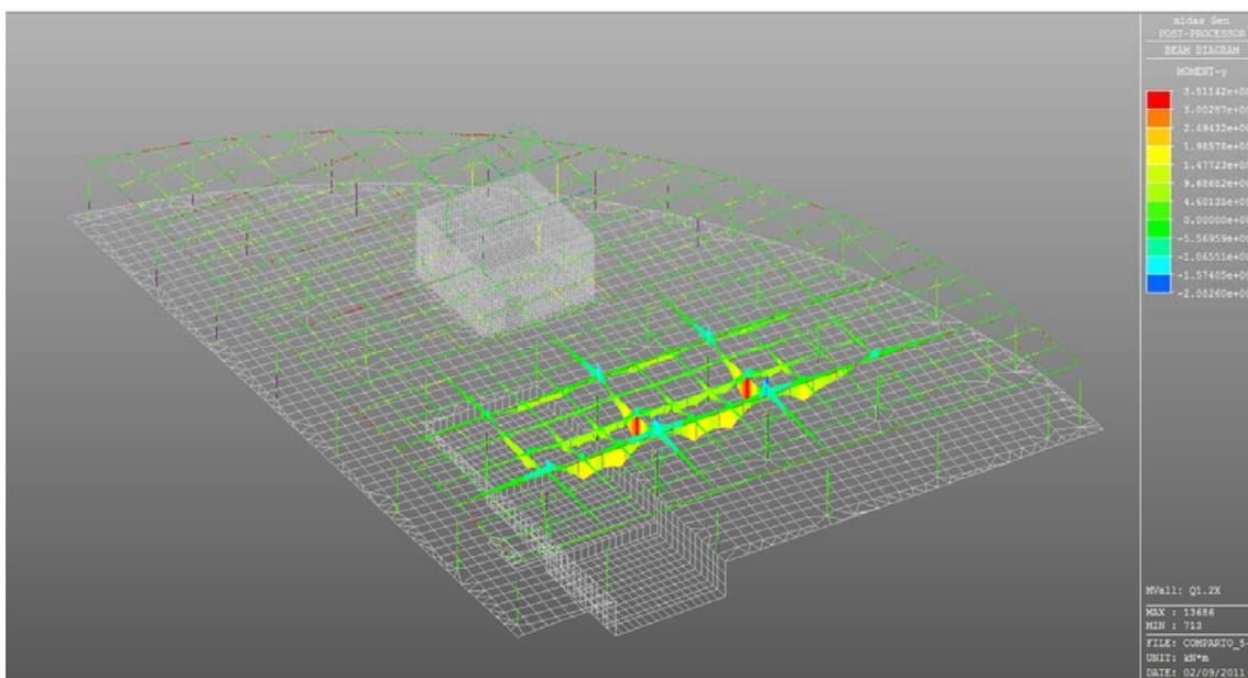
Figura 6.12: Caso di carico Q1 (traffico) in dir X – Valore del momento flettente
