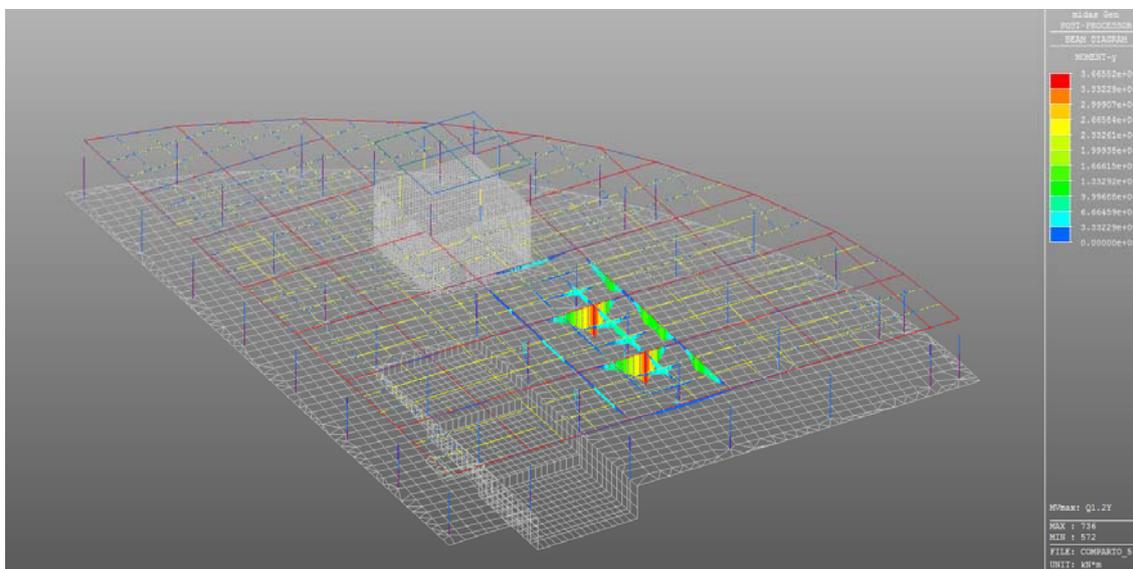
Figura 6.13: Caso di carico Q1 (traffico) in dir Y – Valore del momento flettente
