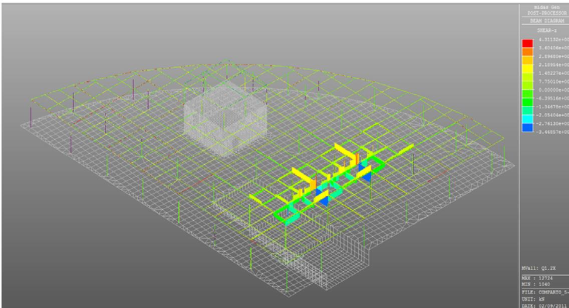
Figura 6.25: Caso di carico Q1 (traffico) in dir X – Valore del taglio
