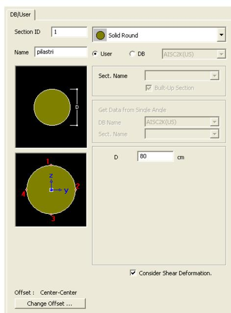
Figura 4.19:Caratteristiche geometriche delle sezioni trasversali dei pilastri
