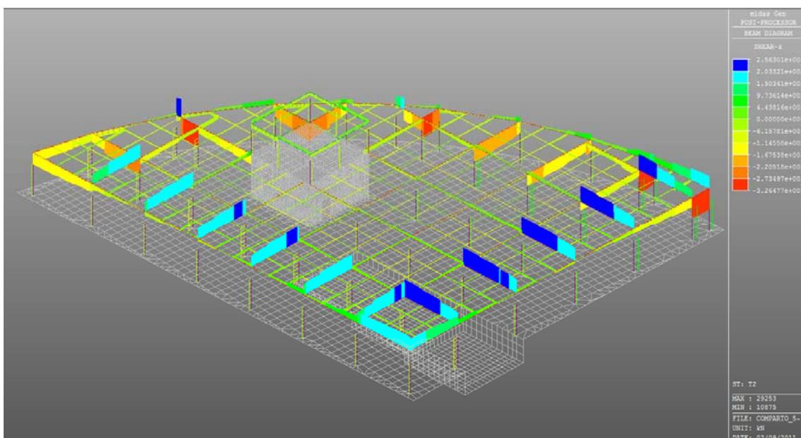
Figura 6.35: Caso di carico T2 (termico) – Valore del taglio
