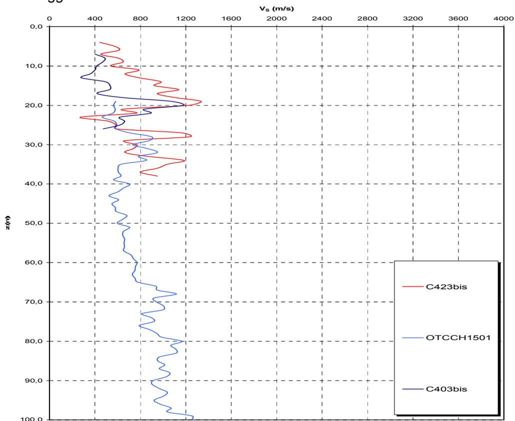
Figura 4.3: Andamento delle Vs nelle verticali indagate
