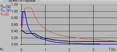
— Spettro di progetto - componente orizzontale
