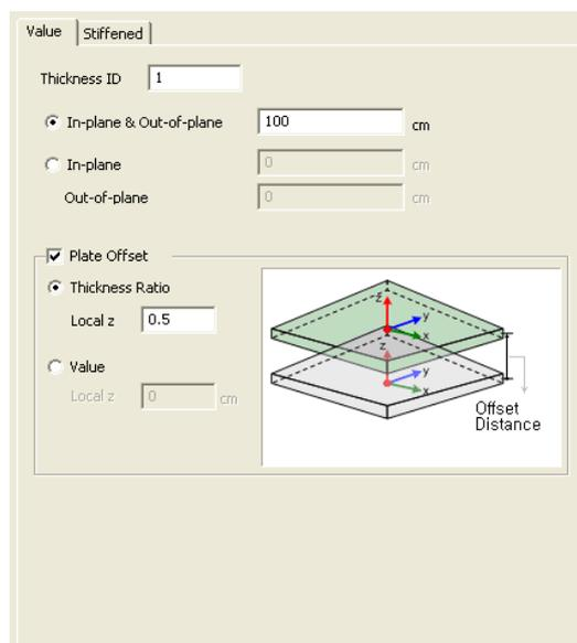
Figura 4.21:Caratteristiche geometriche delle solette
