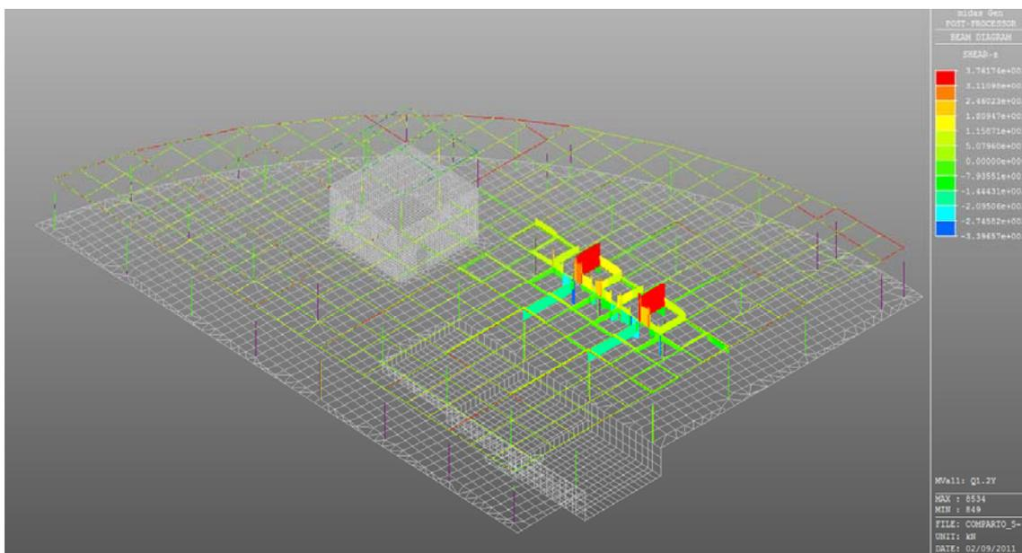
Figura 6.26: Caso di carico Q1 (traffico) in dir Y – Valore del taglio
