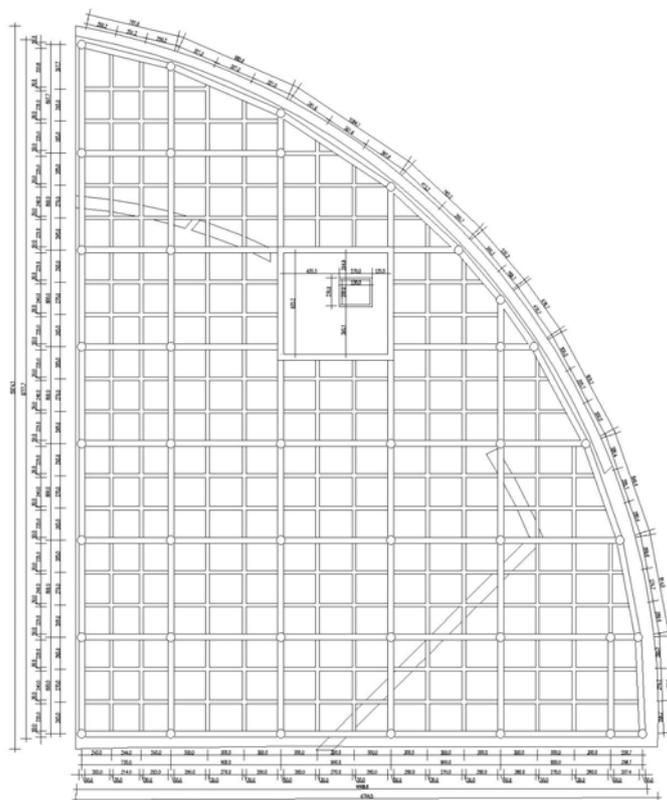
Figura 4.1: Carpenteria del primo impalcato del corpo n. 5
