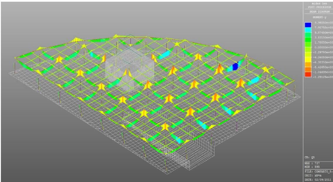
Figura 6.14: Involuppo del carico Q5 (folla) – valore del momento flettente
