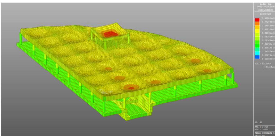
Figura 6.1: Deformate per effetto dei pesi propri strutturali – G1
