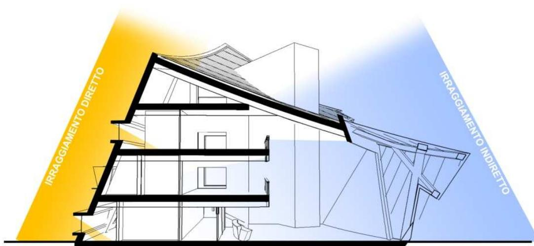
**Comportamento dell'edificio all'irraggiamento diretto e indiretto: sezione**
