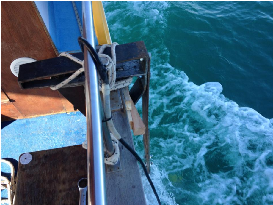
Figura 1.4 – Sistema di fissaggio del sensore in paratia.
