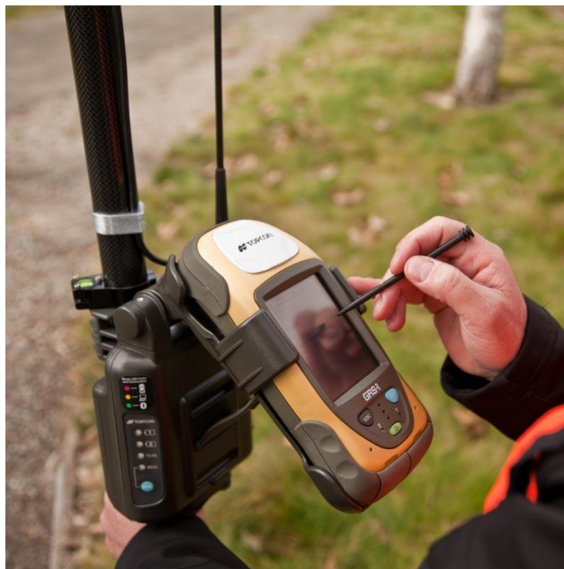
Figura 1.8 - Ricevitore Topcon GRS-1.
