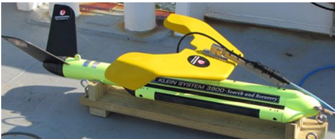
Figura 1.12 – "Tow Fish" del sistema Side Scan Sonar Klein 3900.
