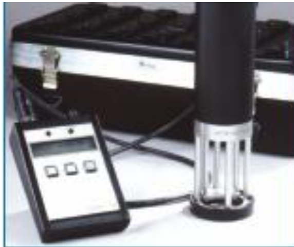
Figura 1.7 – Sonda di Velocità del suono RESON SVP/15.
