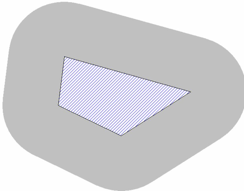
Area di raccolta per fulminazione diretta della struttura      $Ad = 1,43E-02 \text{ km}^2$
