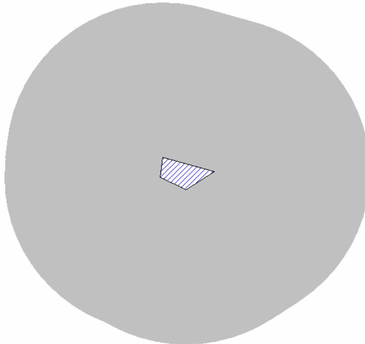
Area di raccolta per fulminazione indiretta della struttura  $A_m = 2,56E-01 \text{ km}^2$
