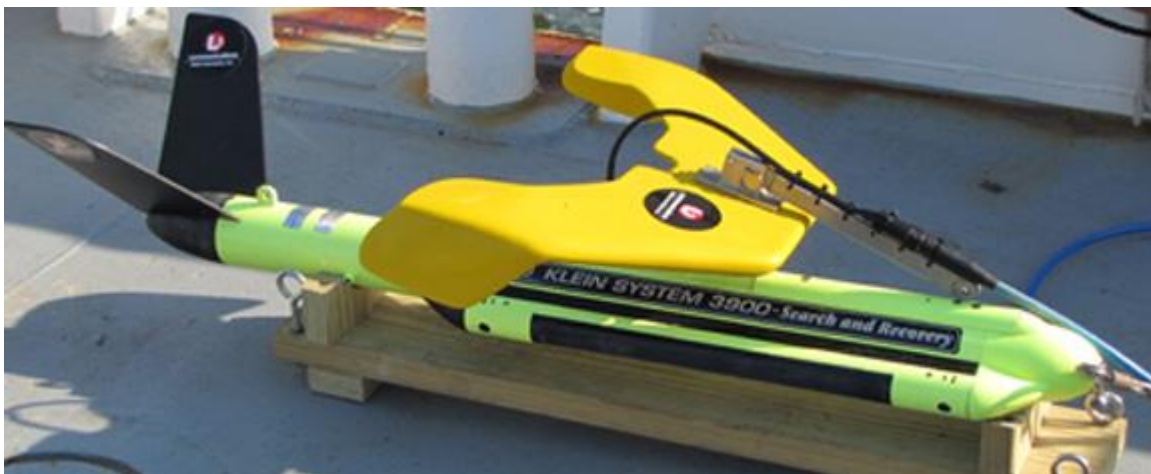
Figura 4.1 – "Tow Fish" del sistema Side Scan Sonar Klein 3900.
