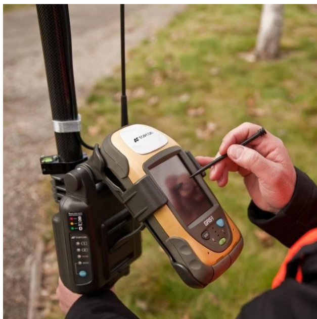
Figura 3.4 - Ricevitore Topcon GRS-1.
