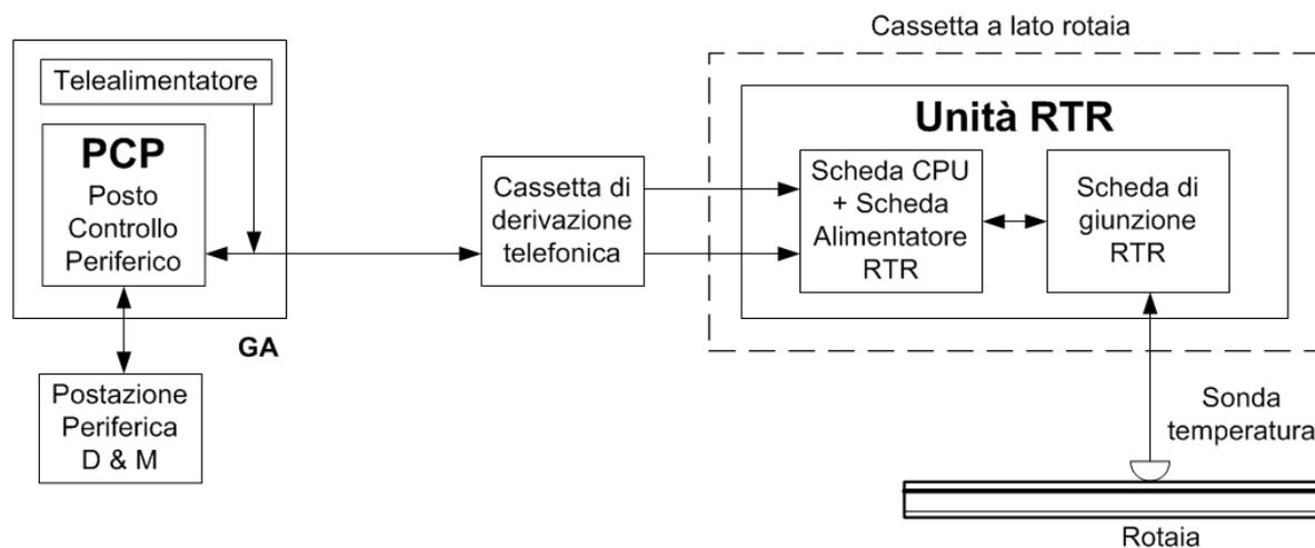
**Figura 7 Dettaglio del Posto di Controllo Periferico**
