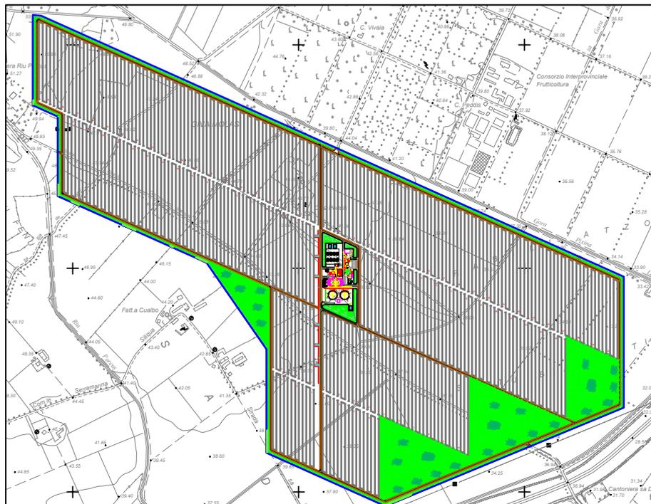
**Figura 5: Layout impianto CSP "Flumini Mannu" campo solare Sener SNT2 optimized**
