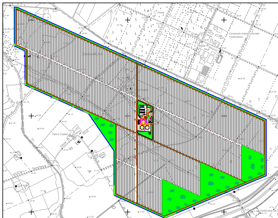
Figura 3: Layout impianto CSP "Flumini Mannu" campo solare Sener SNT2 optimized
