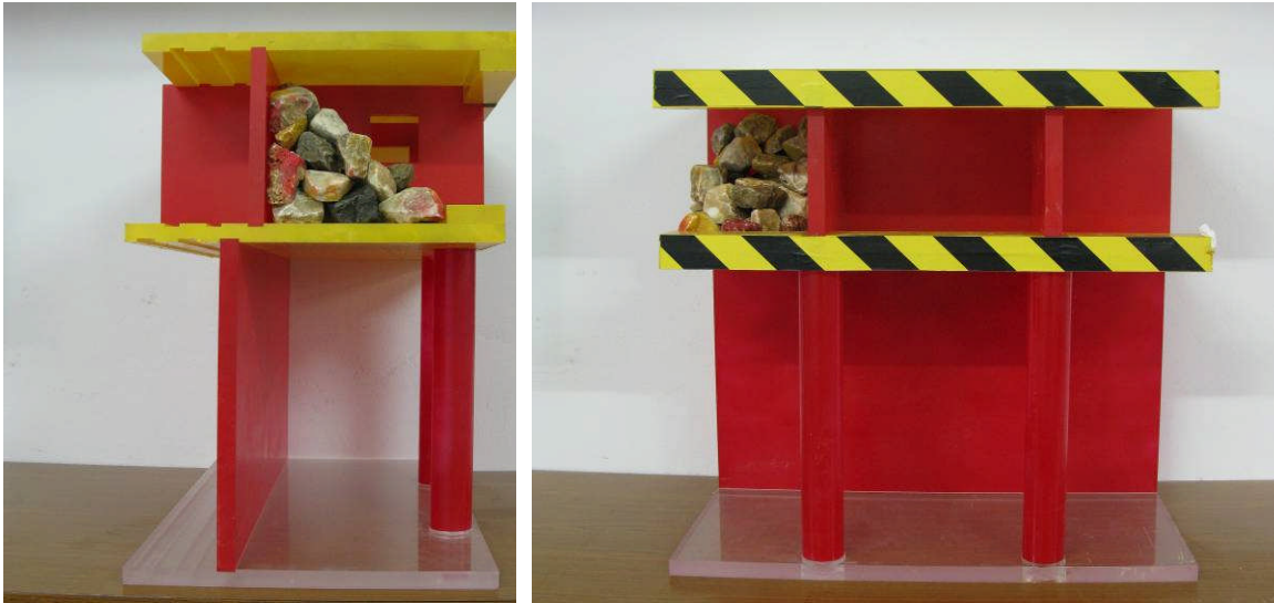
Figura 5: Modello della banchina con cella antiriflettente.
