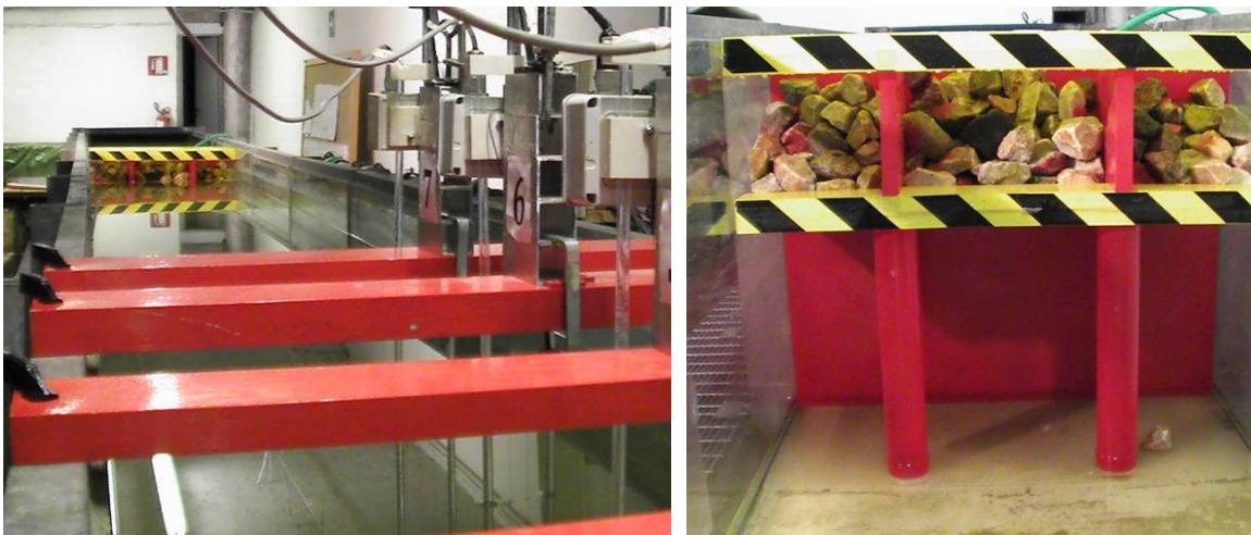
Figura 6: Modello completato con massi da 340g nel canale pronto per le prove.
