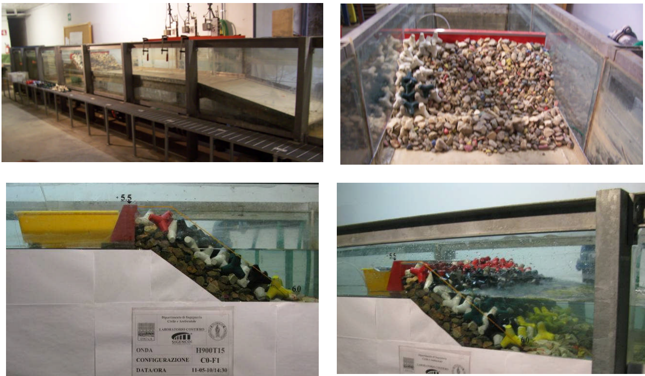
Figura 10: Sezione del modello in fase di costruzione e di prova.
