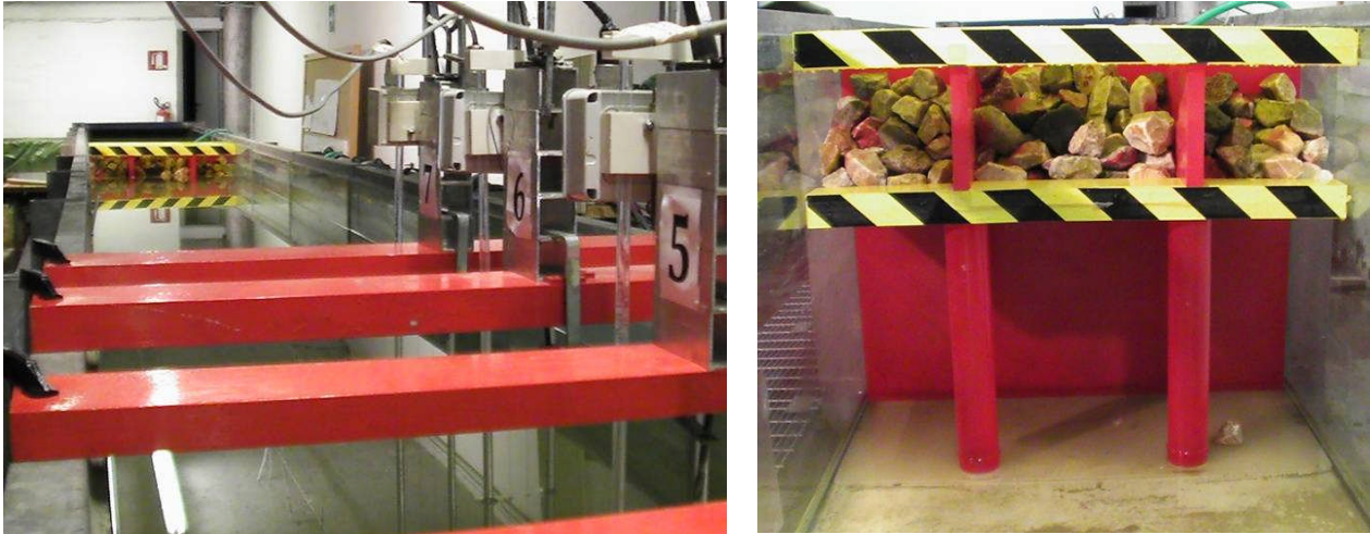
Figura 6 b: Modello completato con massi da 340g nel canale pronto per le prove.
