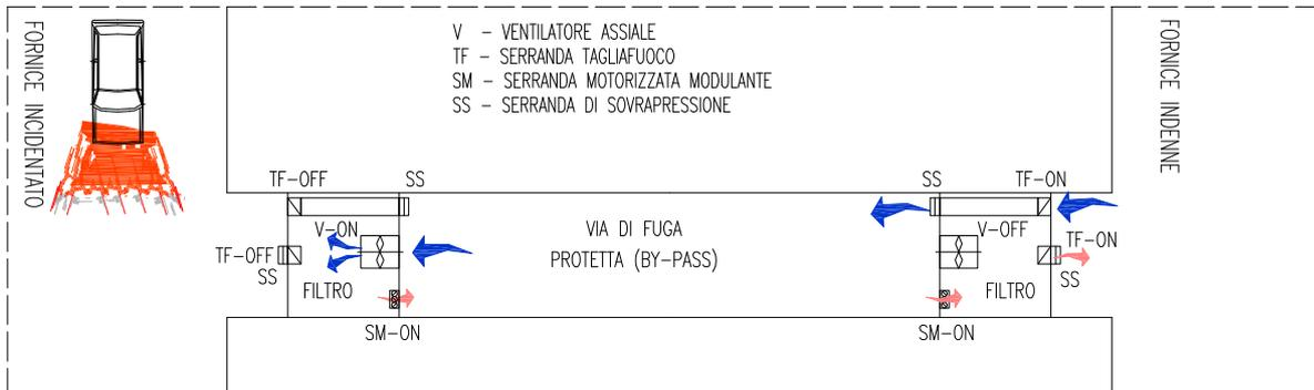
Schema di ventilazione meccanica del filtro a servizio del by-pass pedonale rampe Calabria
