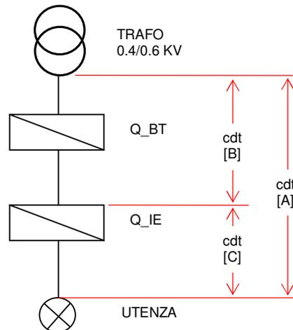
L'origine dell'impianto, caratterizzato da tale livello di tensione nominale, coincide pertanto con i morsetti secondari del trasformatore MT/BT.
