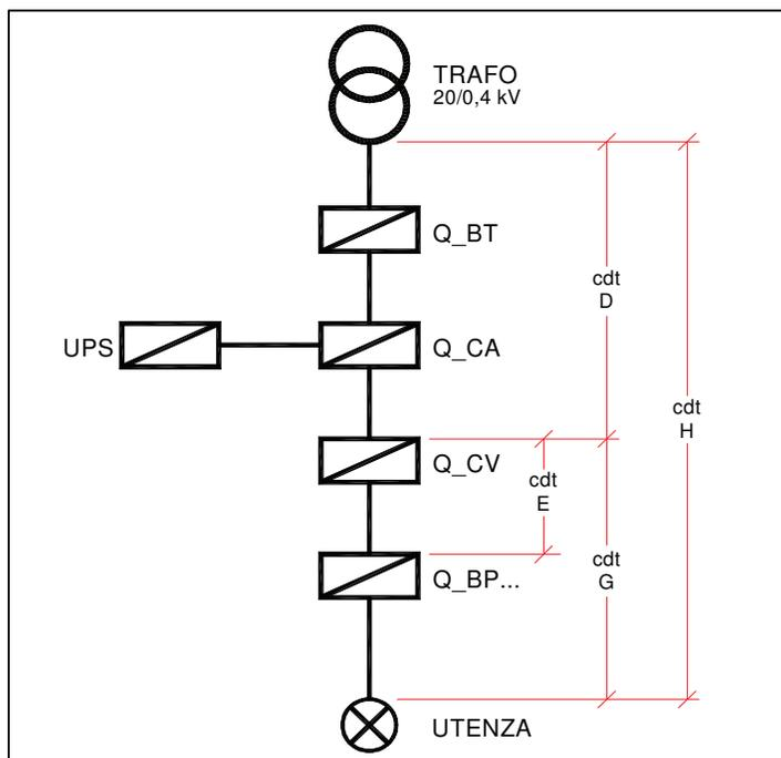
L'origine dell'impianto, caratterizzato da tale livello di tensione nominale, coincide pertanto con i morsetti secondari del trasformatore MT/BT.
