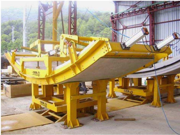
Figure 6.41 Posa della guarnizione perimetrale
