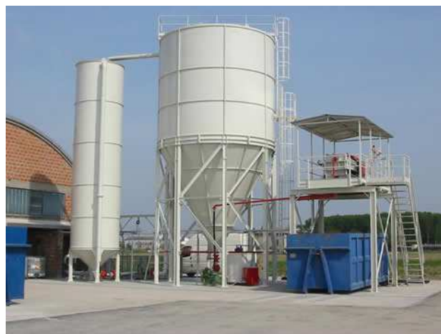
Figure 8.12 Impianti di decantazione acque e disidratazione fanghi
