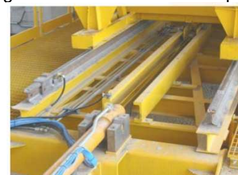
Figure 6.29 Sistema idraulico di trasferimento dei carrelli dal/al forno
