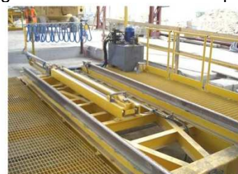
Figure 6.29 Sistema idraulico di trasferimento dei carrelli dal/al forno
