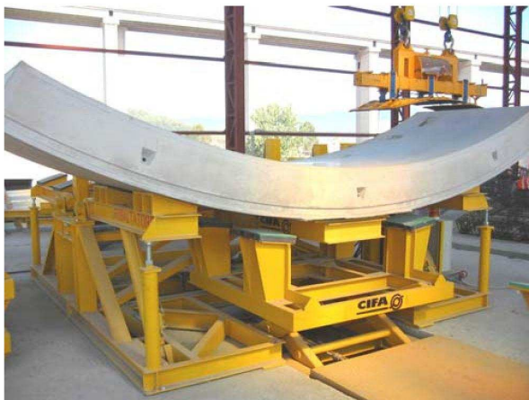
Figure 6.38 Traslazione del concio con meccanismo a pantografo
