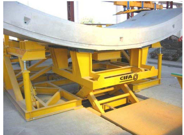
Figure 6.38 Traslazione del concio con meccanismo a pantografo
