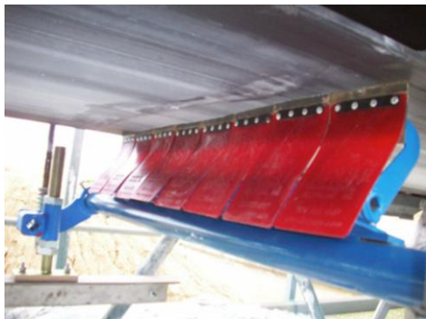
b: raschiatore secondario dopo la puleggia di coda
