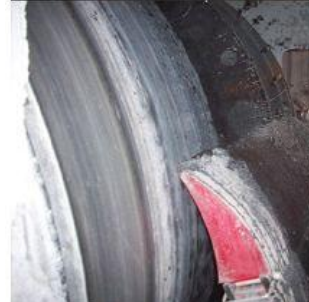
a: raschiatore primario alla puleggia di coda
