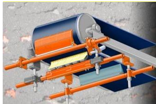
c: raschiatore primario e raschiatori secondari
