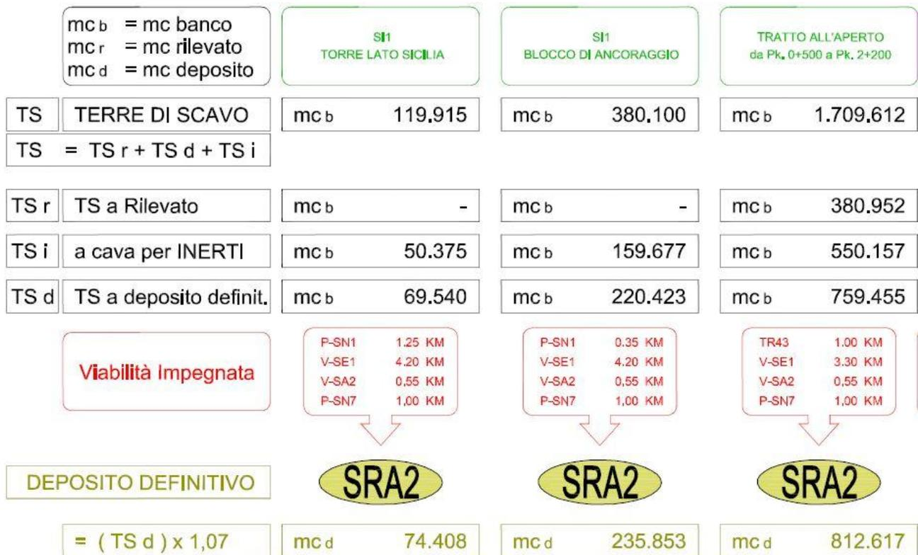
Figura 3.1 Flussi di materiali in uscita dal cantiere (terre da scavo)
