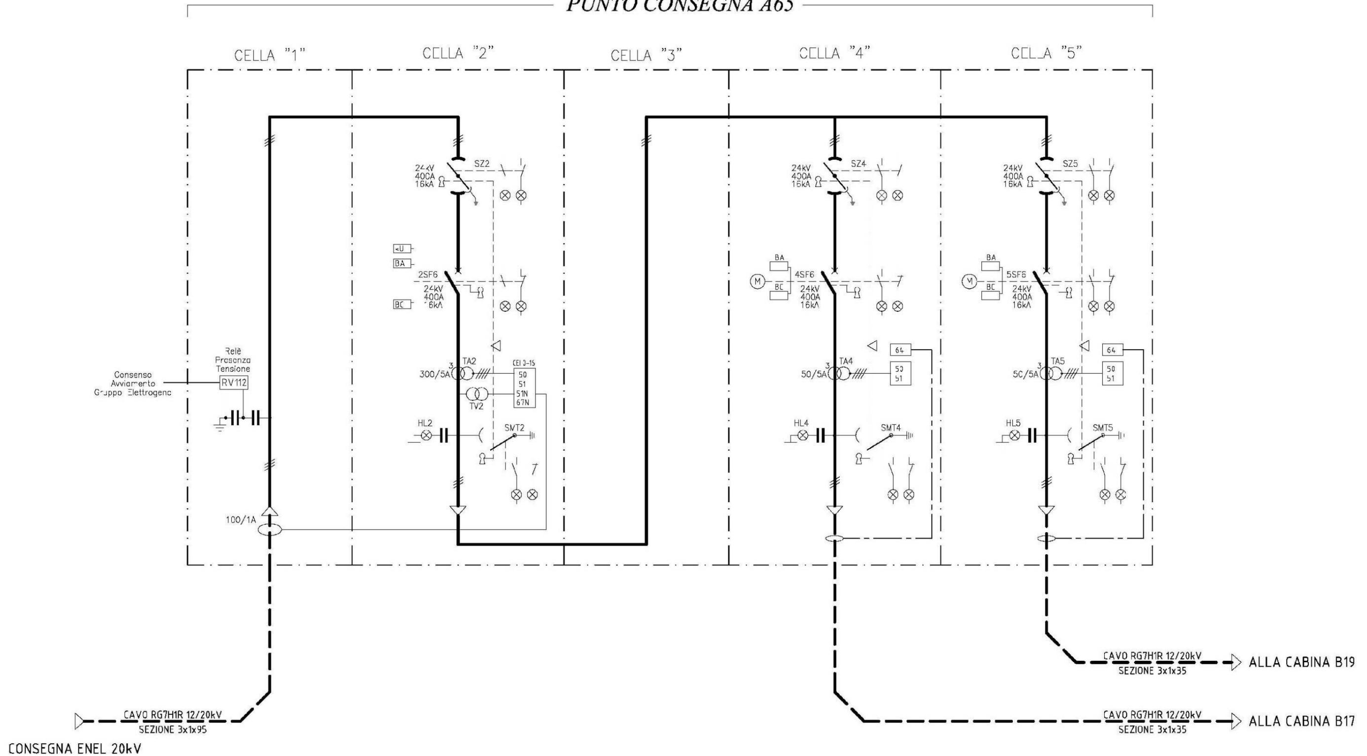
ALLEGATO 4 Schema generale - cabina di trasformazione B17
