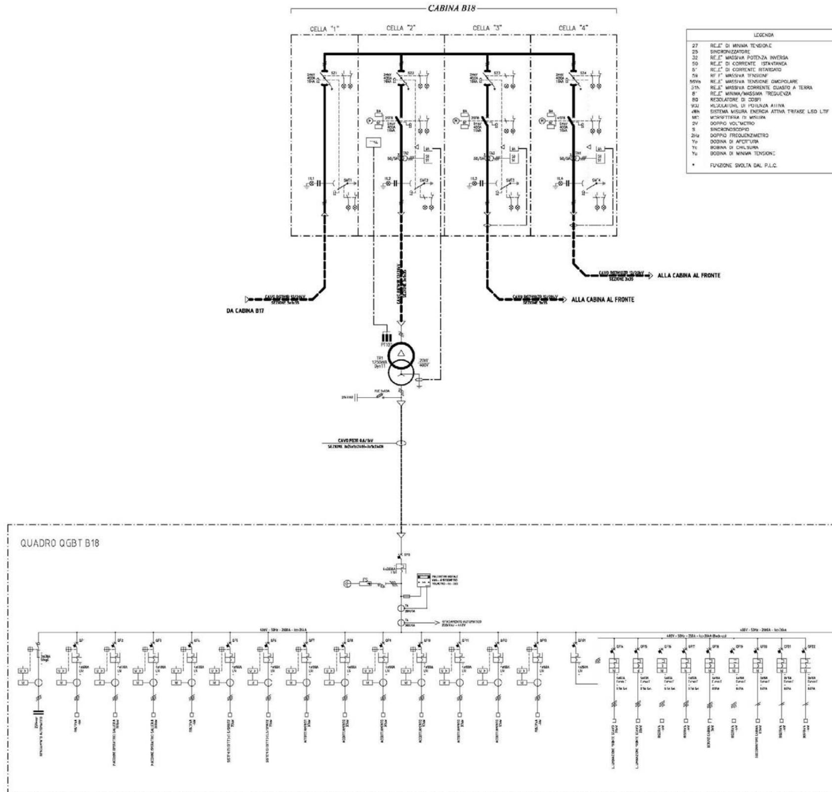
ALLEGATO 6 Schema generale - cabina di trasformazione B19
