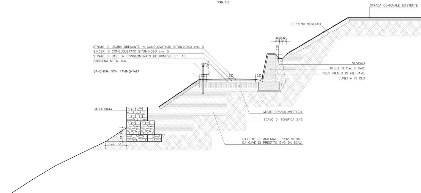
STRATO DI USURA DRENANTE IN CONGLOMERATO BITUMINOSO cm. 3
