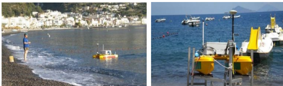
Figura 3.18 Sistema ASV in fase di mobilitazione e in fase operativa
