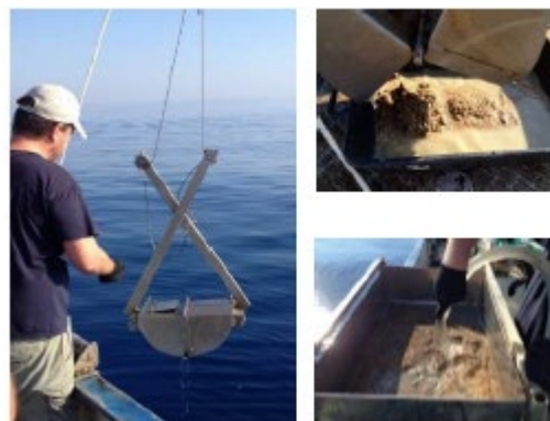
Figura 3.23 Recupero della benna Van Veen e setacciatura sedimenti su maglie di 1 mm
