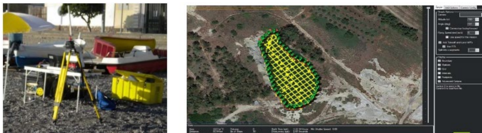
Figura 3.19 Control Ground Station e creazione del piano di navigazione da usare per i rilievi
