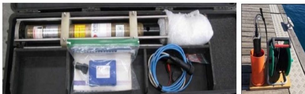
Figura 3.28 Sonda multiparametrica Valeport MKIII (a sinistra), Sonda multiparametrica Horiba (a destra)
