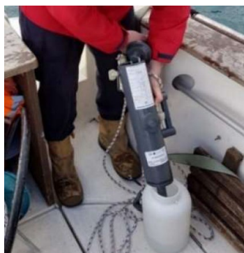
Figura 3.29 Bottiglia Niskin utilizzata per il campionamento di acqua
