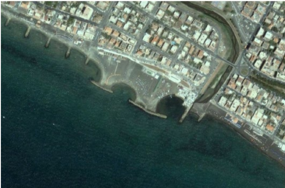
Figura 3.5.40 Formazione del “tombolo” a tergo delle barriere - Ladispoli (Regione Lazio)
