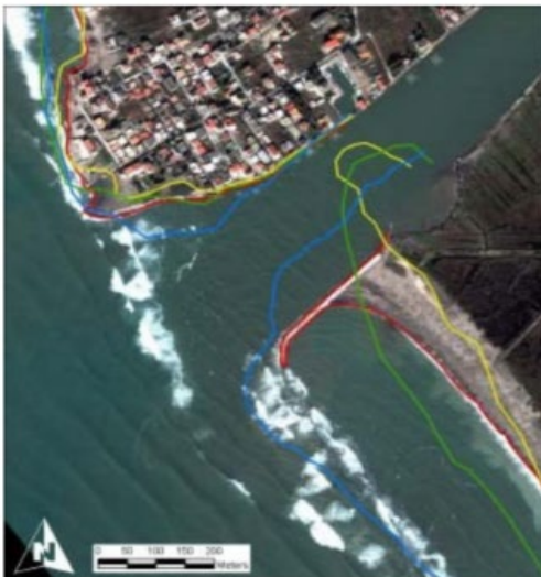
Figura 5.3 Esempio di evoluzione storica della linea di riva (con linee colorate riferite alla posizione delle linee di riva ai diversi anni)
