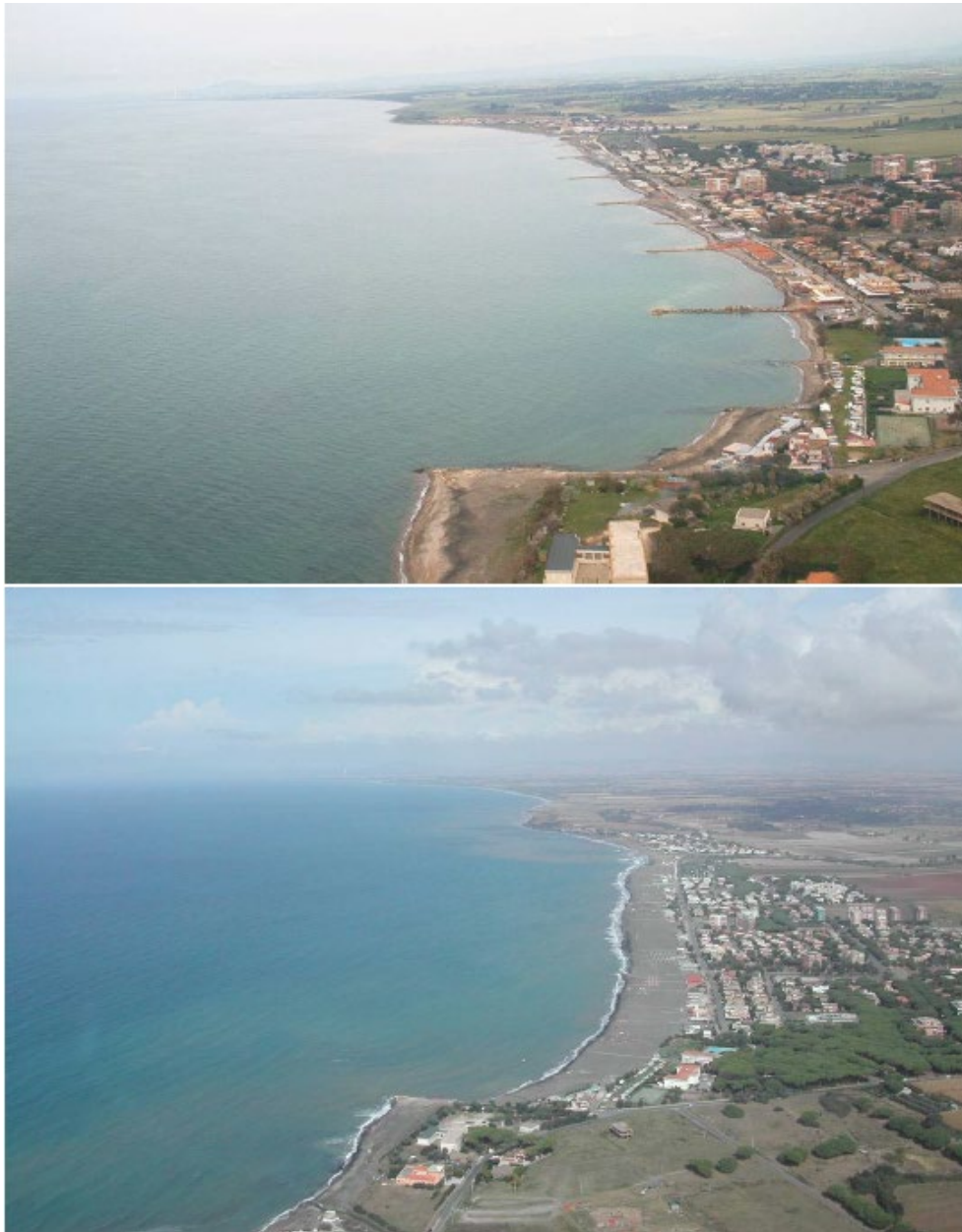
Figura 3.5.35 Litorale di Tarquinia (Regione Lazio) prima (in alto) e dopo (in basso) l'intervento di ripascimento
