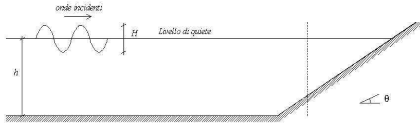
Figura 4.2 Schema adottato per lo studio della riflessione provocata da una parete impermeabile inclinata.
