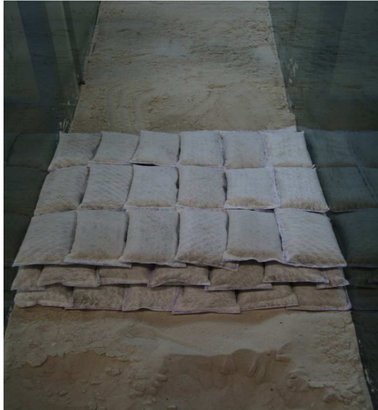
Figura 8.12 Posa del terzo strato della struttura.
