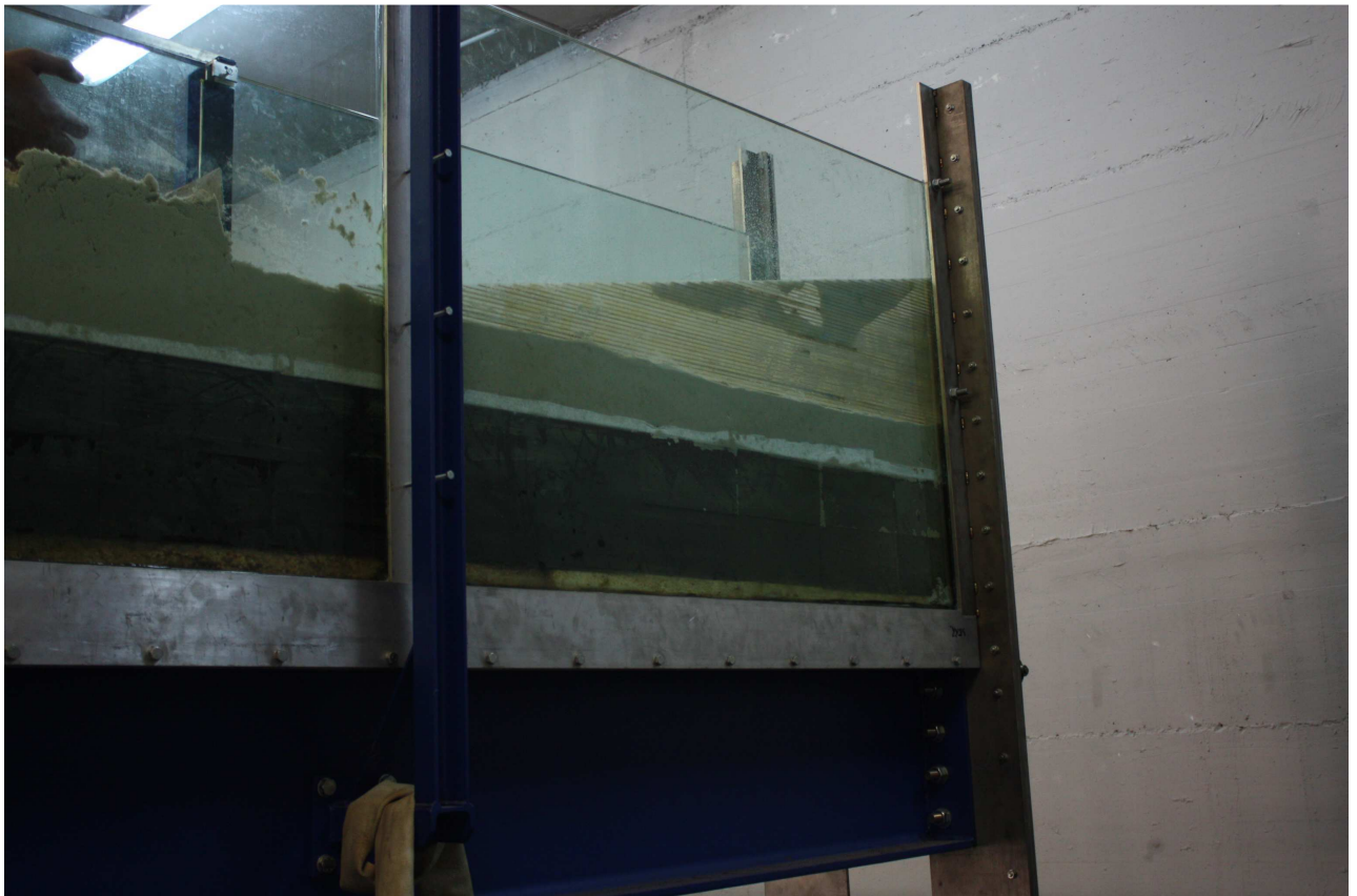
Figura 8.7 Preparazione del profilo di spiaggia: posizionamento di guide laterali per la sagomatura del profilo.
