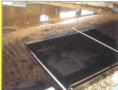
Fotografia 2 Costruzione della spiaggia per Test Serie 1
