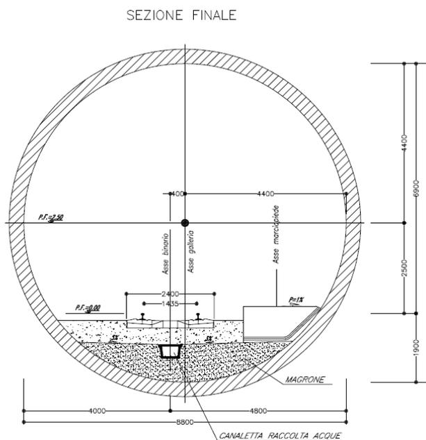
Le strutture di rivestimento sono costituite da conci prefabbricati dello spessore di 40cm.
