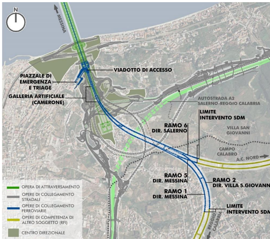
Figura 2-3 – Stralcio planimetrico con indicazione dei rami costituenti i collegamenti ferroviari di progetto sul versante Calabria
