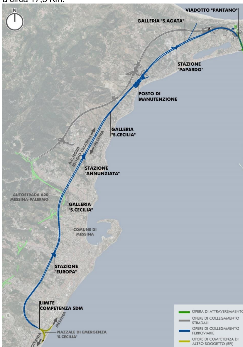
Figura 2-5 – Stralcio planimetrico con indicazione dei principali elementi costituenti i collegamenti ferroviari di progetto sul versante Sicilia
