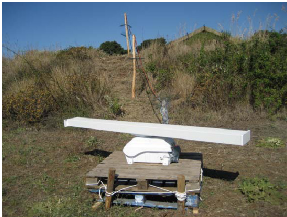
Figura 2-2 – Radar orizzontale posto su supporto di legno per proteggere i cavi dai roditori.
