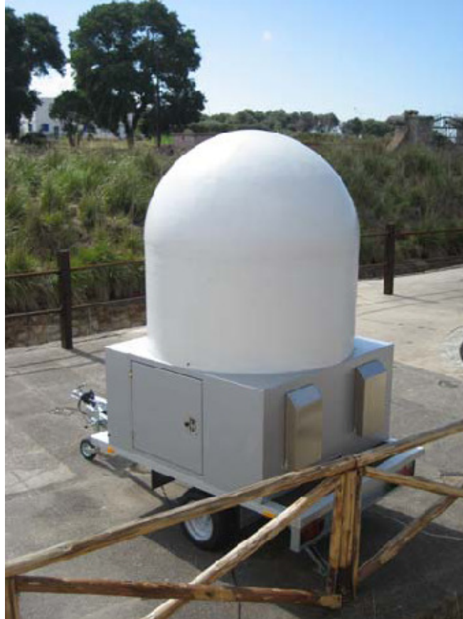
Figura 2-1. Radar a fascio fisso “Swiss BirdScan”. L’antenna di questo radar è collocata dentro la copertura bianca.
