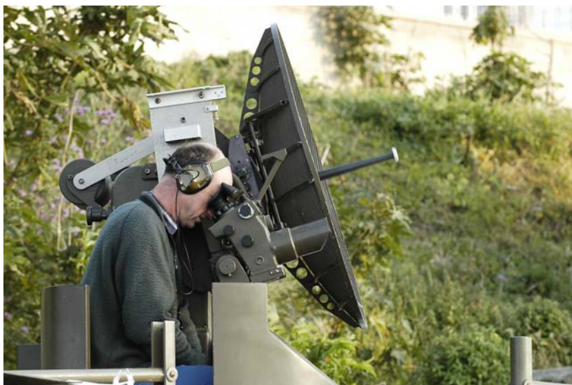
Figura 6: L'osservatore sulla torretta del radar identifica gli uccelli in volo nel fascio del radar attraverso un cannocchiale montato parallelamente all'asse del fascio stesso.
