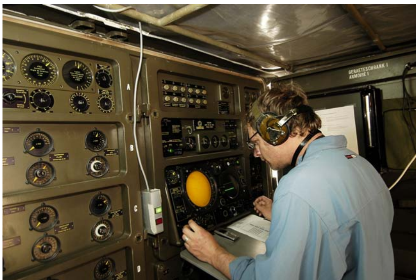
Figura 5: L'operatore radar sta cercando uccelli sullo schermo e li affida al radar che li segue.
