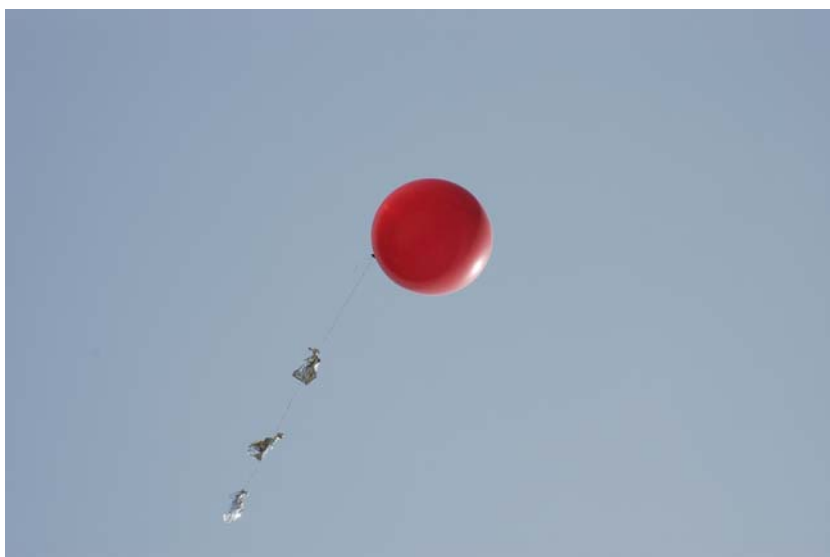
Figura 8: Pallone sonda con un riflettore in alluminio per misurazione del vento.
