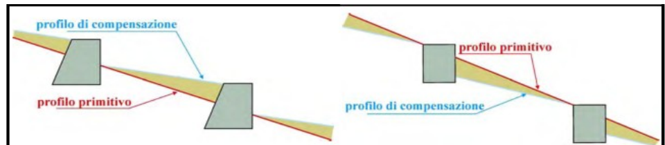
Fig. 6.16 - A sinistra, il profilo primitivo , precedente la realizzazione di briglie, grazie al deposito di materiale detritico, viene modificato (minore pendenza) e stabilizzato in corrispondenza degli apici degli sbarramenti ( profilo di compensazione ). Talora, per evitare costruzioni troppo elevate in altezza, si fa ricorso alle soglie (a destra), opere trasversali analoghe alle briglie, ma con da altezza più contenuta, costruite in modo da non sporgere dal fondo. Esse servono per creare dei punti fissi, inderodabili dalla corrente e, al contrario della briglia che lavora per accumulo di materiale, ottenere il raggiungimento della pendenza di compensazione tramite l'erosione del materiale a valle delle stesse, creando ugualmente una successione di salti raccordati tra loro da livellette a pendenza contenuta.
