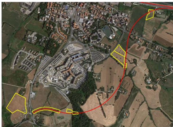
Figura 11 – Interferenze dovute alla costruzione delle aree di lavoro e dei cantieri
