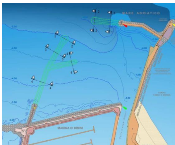
Illustrazione delle opere a scogliera previste nell'ambito di questo progetto (in verde)
