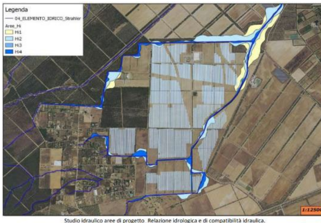
Figura 7 - Rappresentazione delle aree esondabili individuate dallo Studio idraulico delle aree di progetto (cfr. pag. 4 Elaborato R30)
