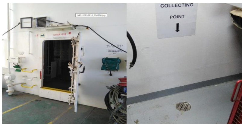
Punto di scarico interno di collegamento con serbatoio “primary bilge tank” in locale chiuso
