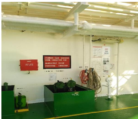
Punto flange di collegamento per scarico rifiuti liquidi all'esterno (acque reflue e acque/olio di sentina).
