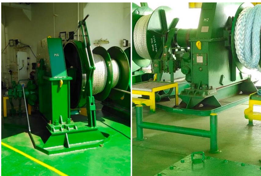
Area impermeabile e cordolata con tappo al di sotto dei verricelli idraulici dei ganci di ormeggio (punto 4.c)
