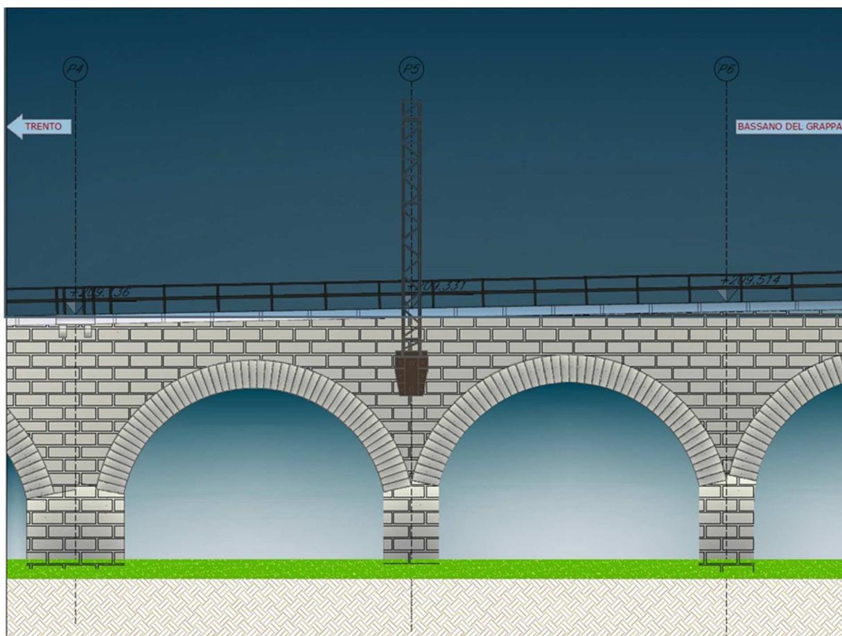
Figura 6– Rappresentazione grafica dell'intervento. Portali T.E. e relativo sistema di ancoraggio.
