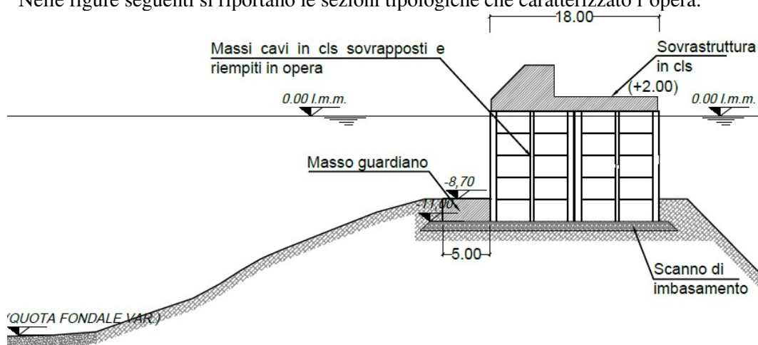
Sezione tipo diga Duca d'Aosta da prog. 535.78 a prog. 1526.84
