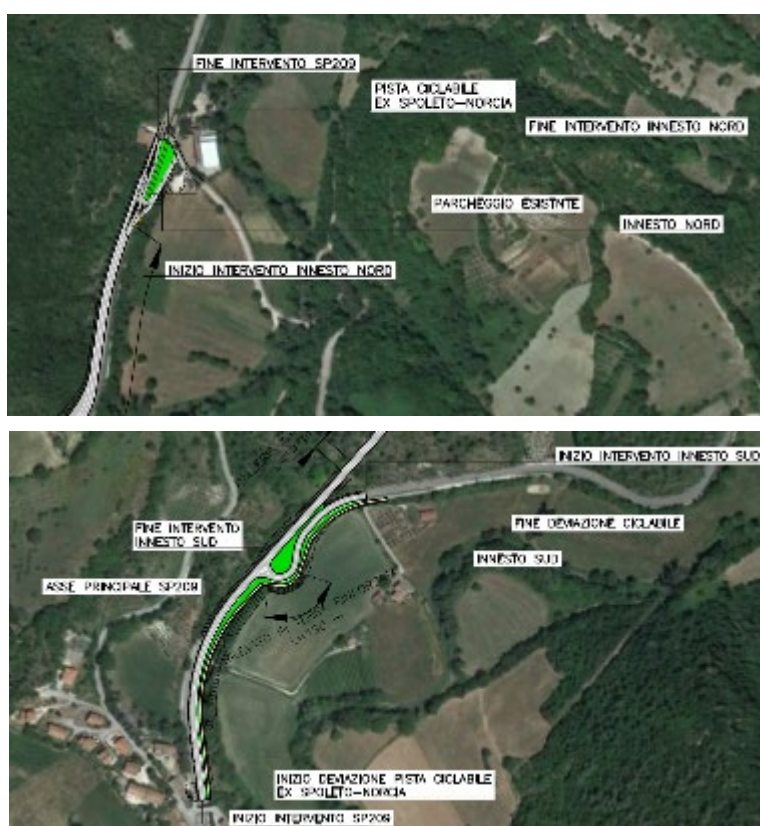
Figura 8 Estratto dall'Elaborato Grafico D005_T00PS00TRAPL01_A – Realizzazione dell'innesto Nord (sopra) e dell'innesto Sud (sotto)
