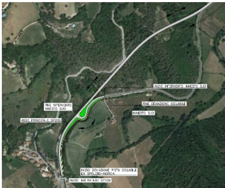
Figura 7 Estratto dall'Elaborato Grafico D005_T00PS00TRAPL01_A – Tratto in variante dell'attuale tracciato con la realizzazione della Galleria artificiale (di lunghezza pari a L = 15 m), Galleria naturale (di lunghezza pari a L = 440 m) e Galleria artificiale (di lunghezza pari a L = 35 m)
