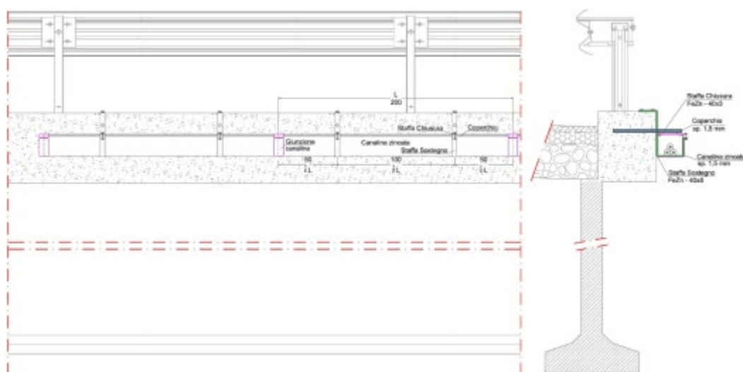
Figura 9 - Dettaglio posa elettrodotto al ponte
