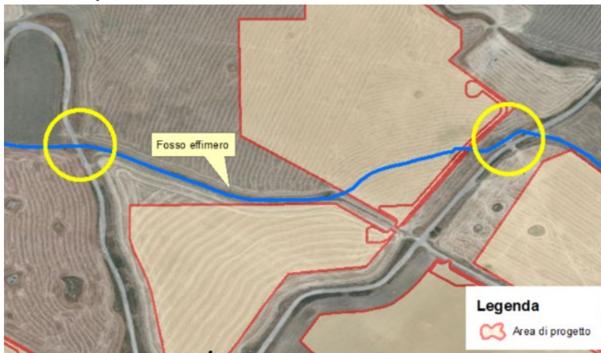
Figura 6 - Attraversamenti del fosso effimero a raso della sede stradale. Fonte: elaborazione della Commissione
