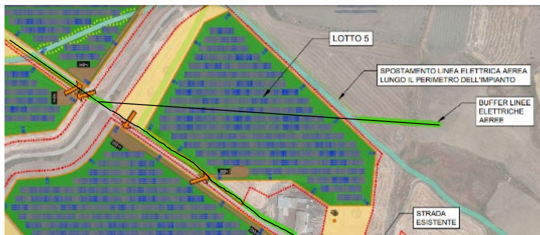
Figura 5 - Estratto della tavola “AR05-LayoutImpianto-R0.pdf” con sovrapposizione delle linee aeree esistenti (linea nera elaborata dalla Commissione). Spostamento della linea elettrica aerea, attualmente interna al Lotto 5, lungo il perimetro dell'impianto
