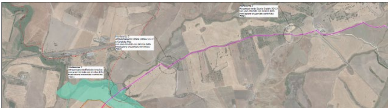
Figura 4 - Interferenze lungo il percorso dei cavidotti
