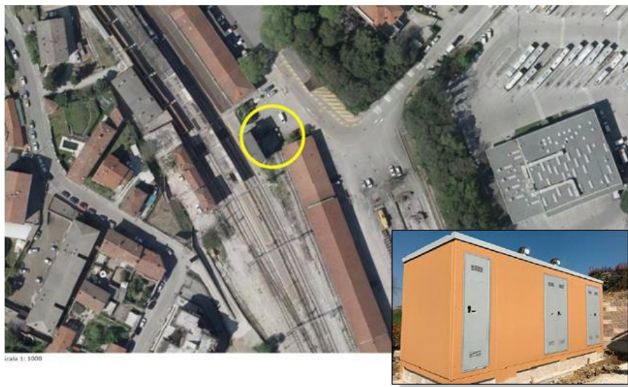
Figura 13 – Posizionamento cabina prefabbricata. Nel dettaglio cabina standard Enel DG2092
