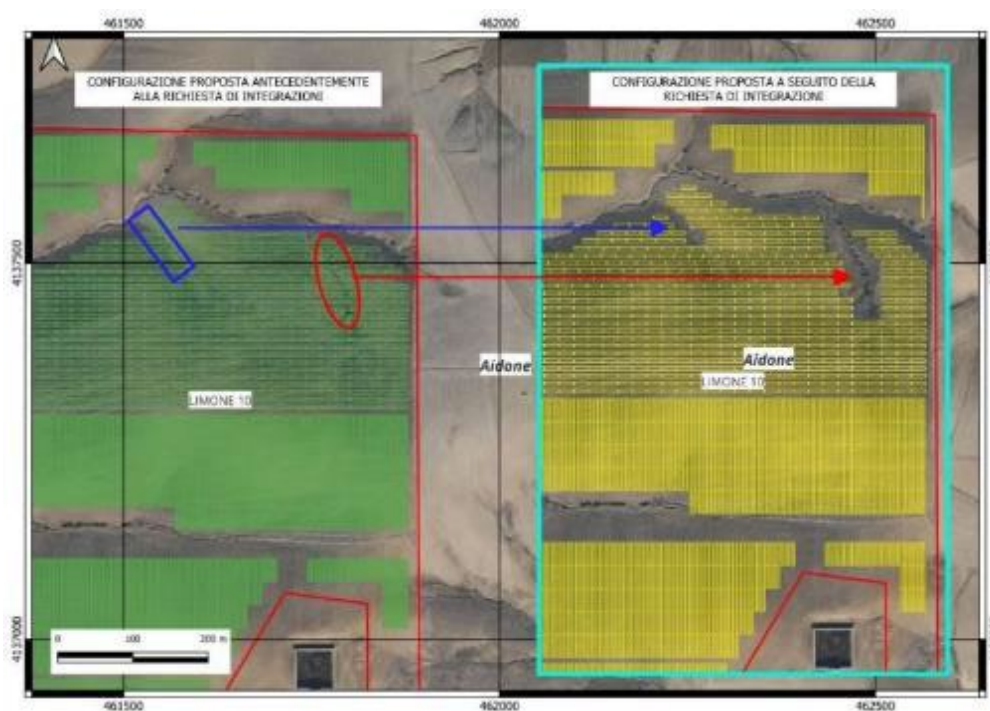
Figura 16. Modifica del layout del sottocampo 10. Nel rettangolo blu e nell'ellisse rosso sono evidenziate le modifiche intercorse a seguito della richiesta di integrazioni. Elaborazione della Commissione sulla base dei dati vettoriali forniti dal Proponente.
