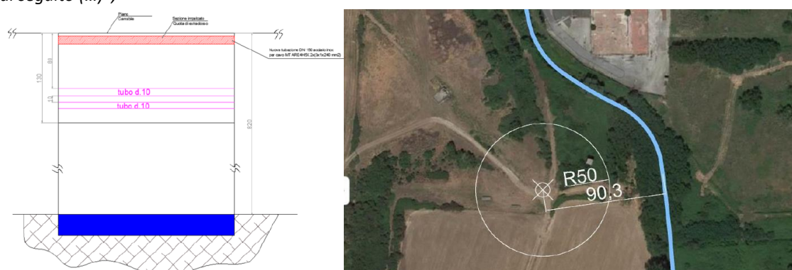
Fig. 10 – Schemi di Attraversamento fuori terra della tubazione e nuova posizione della cabina di sezionamento e distanza dall'alveo del fiume
