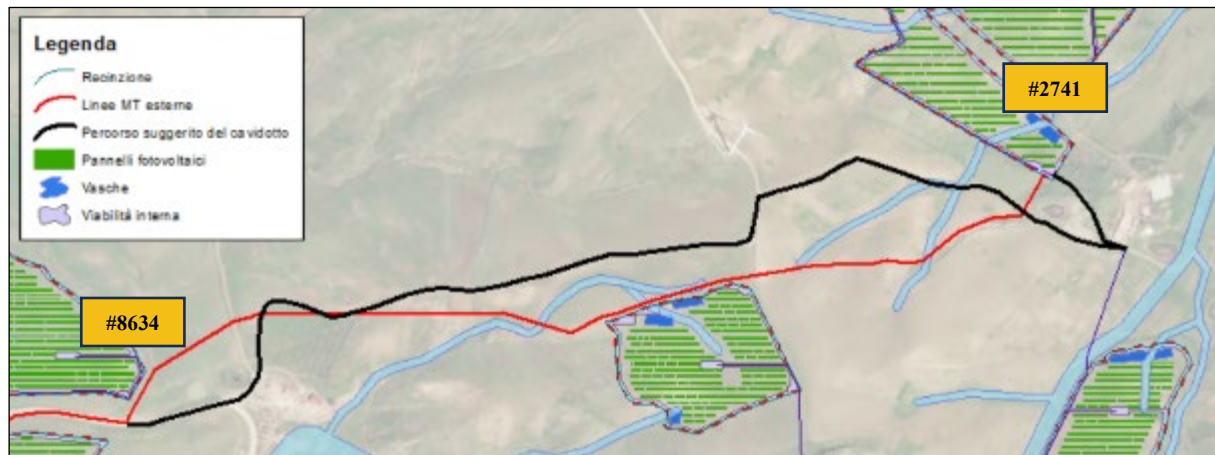
Figura 5 - Interferenze del cavidotto proposto (strato informativo “linee MT esterne”, linea di colore rosso) con le aree di rispetto degli impluvi e alternativa di percorso del cavidotto (linea di colore nero). Fonte: elaborazione della Commissione
