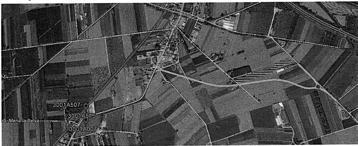
L'intervento si sviluppa su un terreno pressoché pianeggiante in rilevato basso e presenta uno sviluppo complessivo di circa 1125 m oltre le zone di incrocio, con una intersezione ad Est, mediante l'inserimento di una rotatoria, con la SP 74 "Ponte dei Cani", mentre all'estremità a Ovest è prevista una intersezione temporanea a T con la ex SS 162, intersezione che verrà trasformata in rotatoria a 4 rami nel progetto completo della Variante Cancellò.
