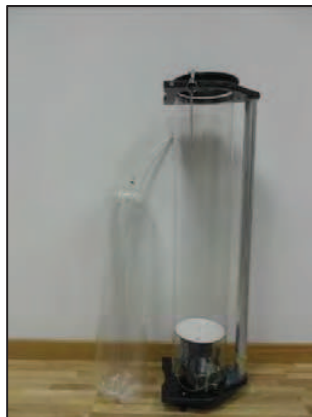
Figura 4.5. Campionatore passivo e contenitore in nalophan
