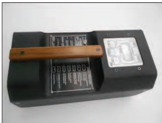
Figura 4.6. Analizzatore portatile di idrogeno solforato Jerome 631-XE
