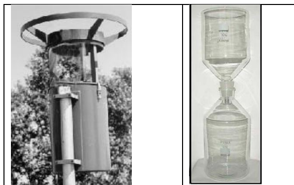
Figura 4 - Vista esterna del deposimetro (a sinistra); parte interna (imbuto e bottiglia) (a destra).
