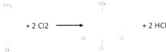
Il PCBTC (para-cloro-benzo-tricloruro) è prodotto nella sezione di fotoclorurazione esistente; esso viene trasferito nella sezione per la clorurazione in anello. Qui si procede al carico dei due reattori (volume  $7,5 \text{ m}^3/\text{cad}$ ) con circa  $8.000 \text{ kg}/\text{batch}$ . Al termine si procede al carico del catalizzatore ( $\text{FeCl}_3$  circa  $1,5 \text{ kg}/\text{batch}$ ).
