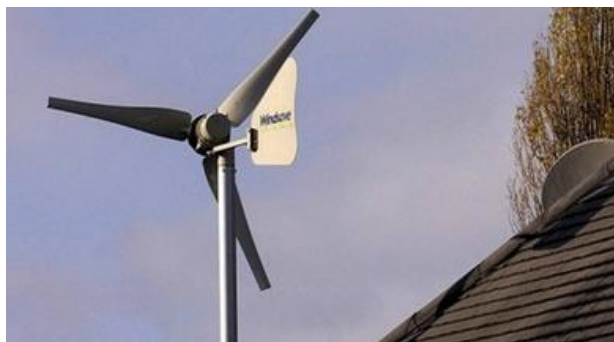
Generatore micro eolico con timone direzionale
